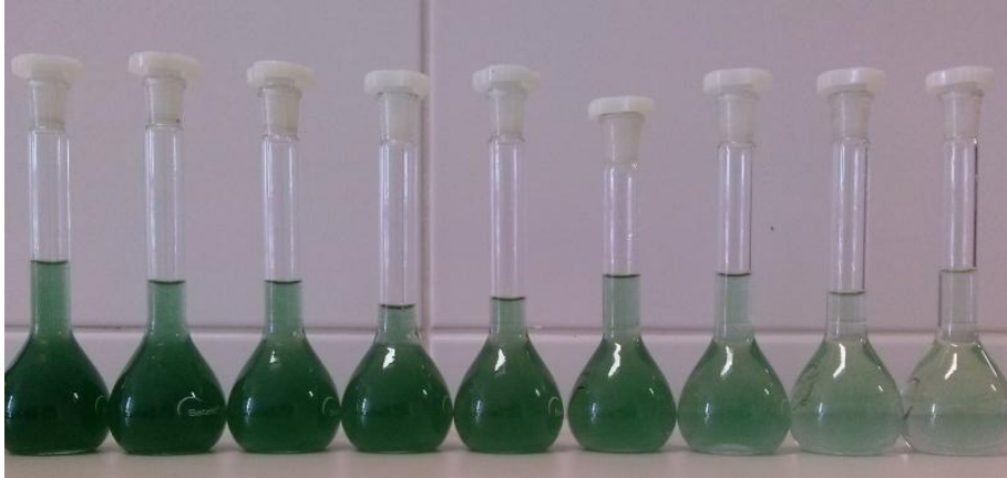
Figura 13 - Diluições utilizadas para curva padrão.
