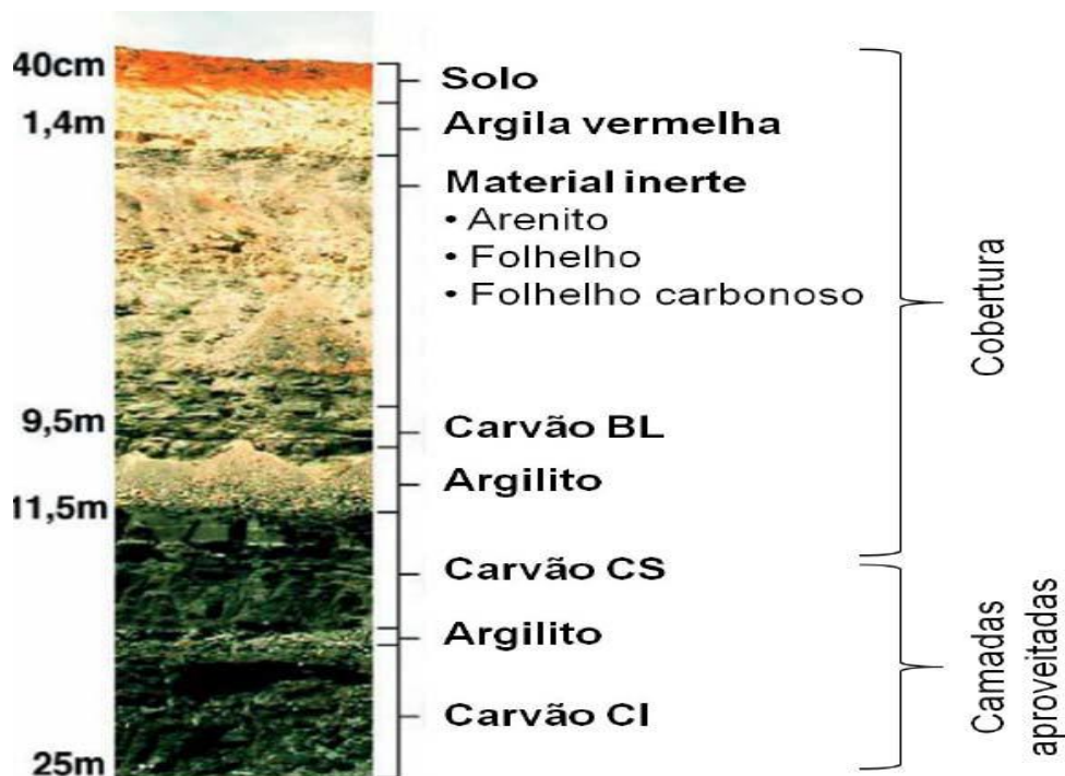
Figura 4 - Representação do perfil geológico da formação Rio Bonito na Jazida de Candiota, RS.
