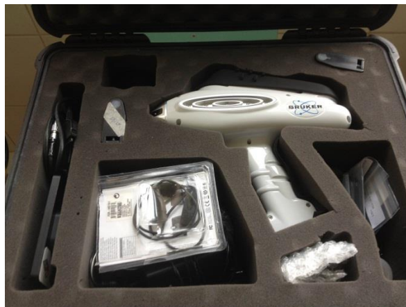
Figura 7 - Espectrômetro de fluorescência de raios-x da marca Bruker, modelo S1 Turbo SD.
