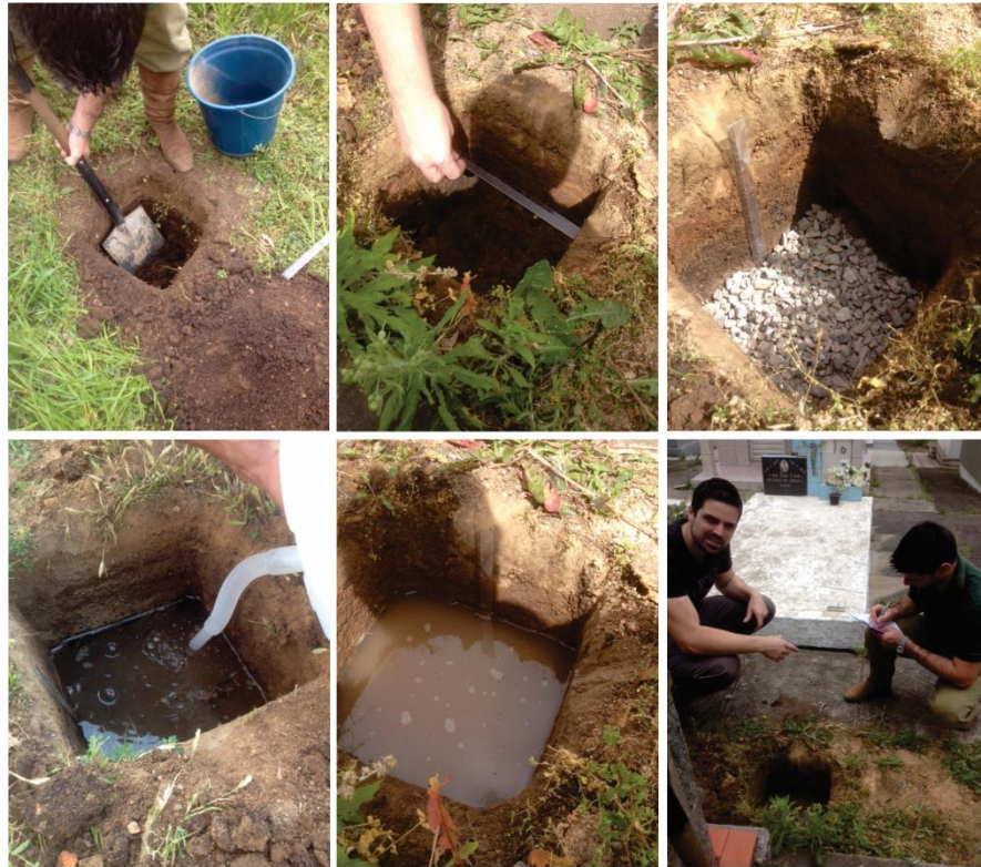
Figura 9 - Execução do ensaio de infiltração em campo.
