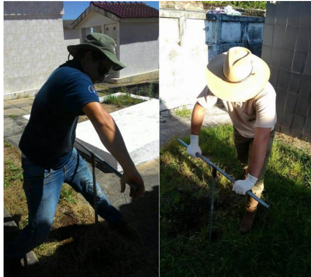
Figura 5 - Coleta de solo com trado manual.
