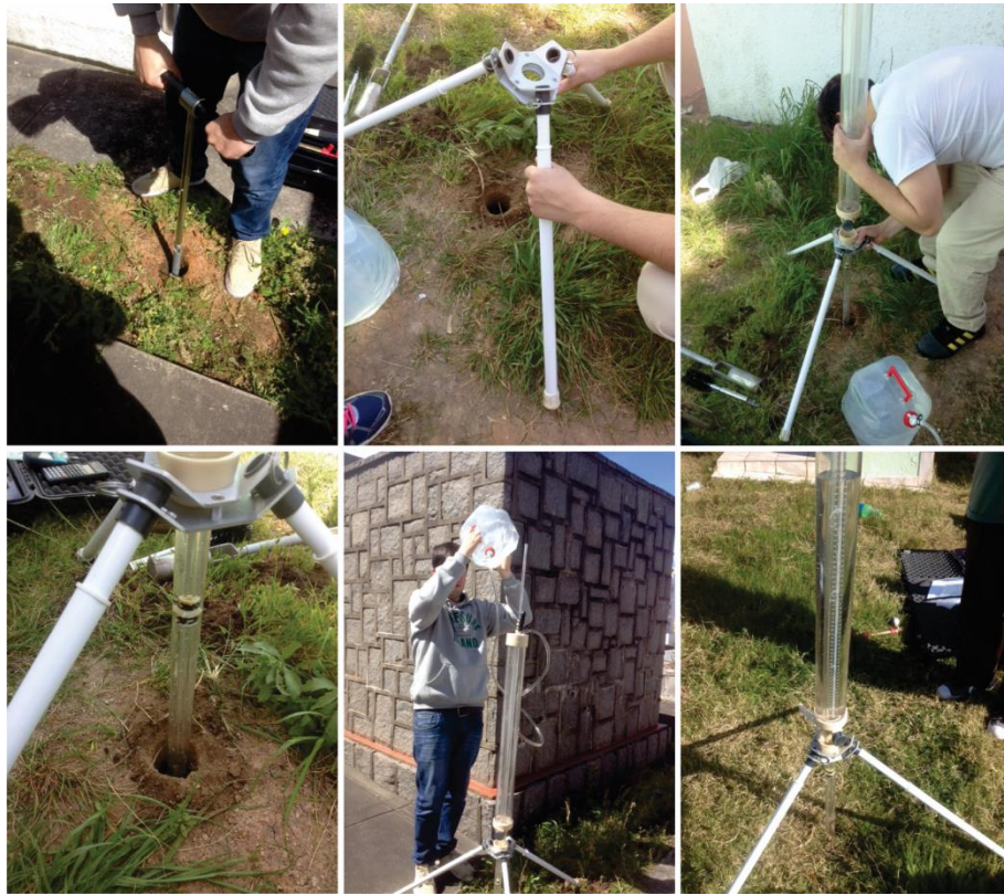
Figura 8 - Utilização do permeâmetro Guelph em campo.
