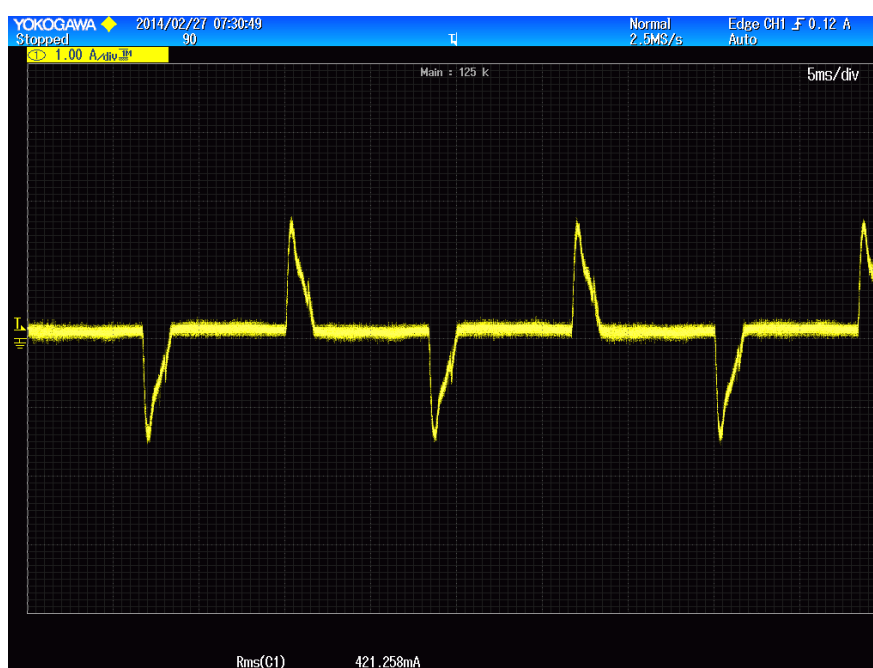
Figura 13. Forma de onda da corrente do reator eletrônico para lâmpada de 50W.
