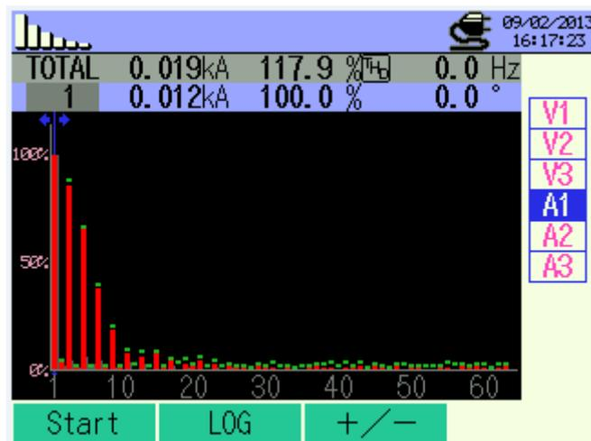
**Figura 12 - Distorções harmônicas do motor atuando com a carga e com frequência de 36 Hz.**
