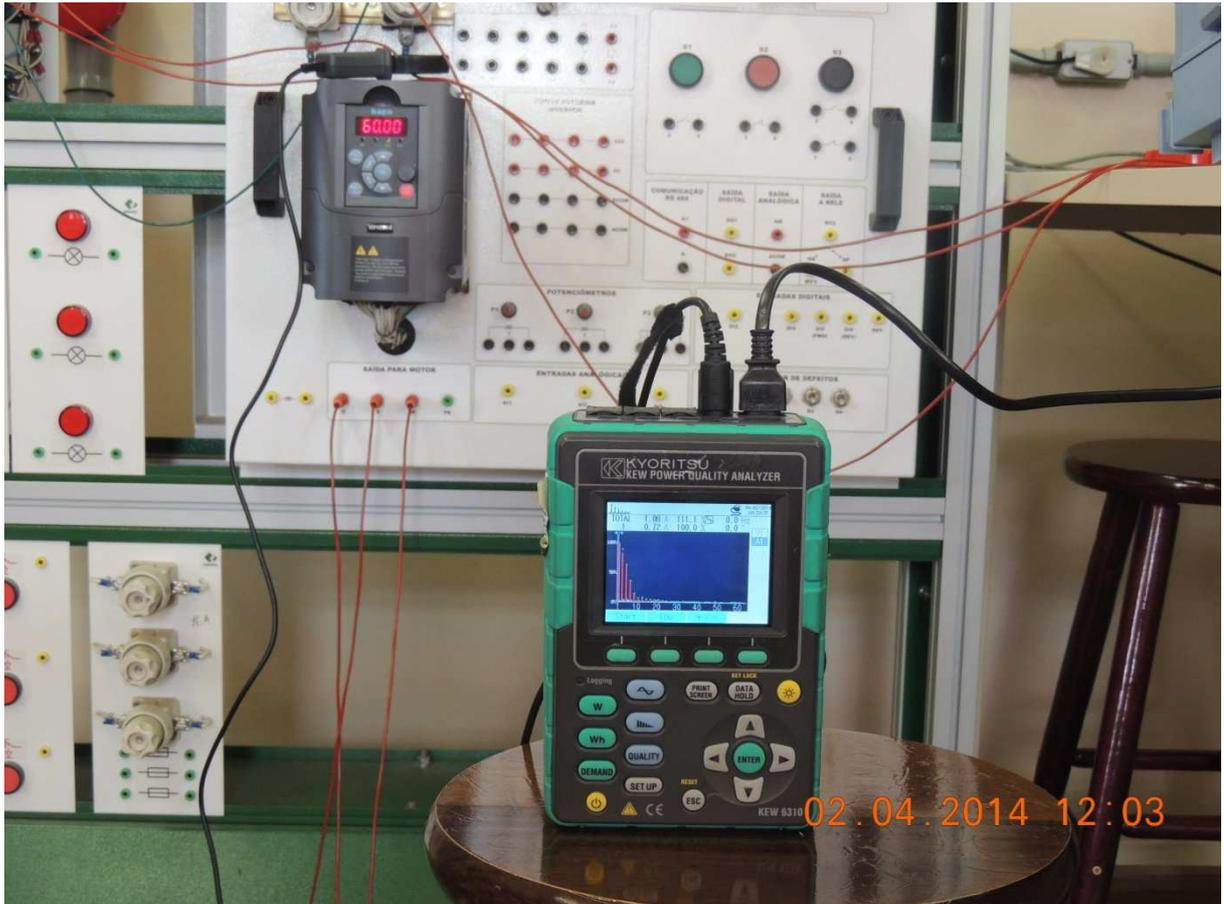
**Figura 24 - Analisador de energia digital.**
