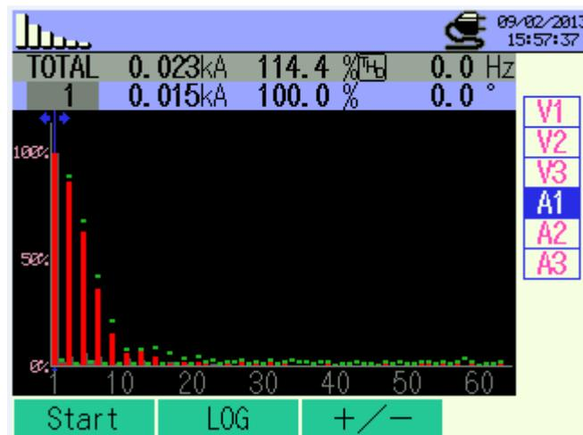
**Figura 64 - Distorções harmônicas do motor atuando com a carga e com frequência de 60 Hz.**
