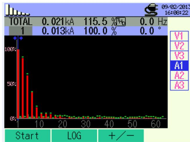
**Figura 56 - Distorções harmônicas do motor atuando com a carga e com frequência de 48 Hz.**
