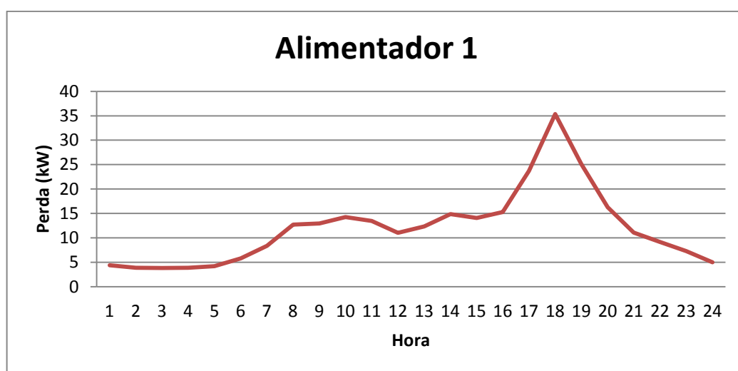
Figura 16 – Perdas elétricas no Alimentador 1, carga predominantemente residencial.
