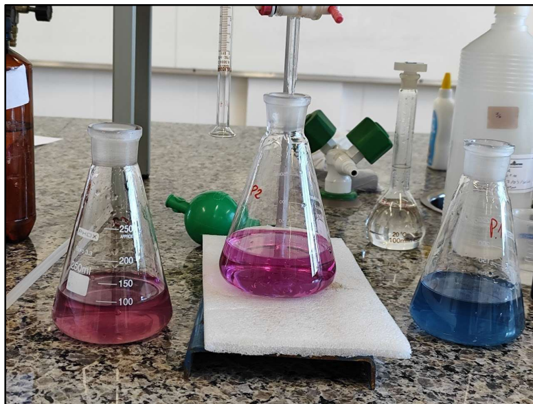
Figura 8- Análise de dureza por titulometria
