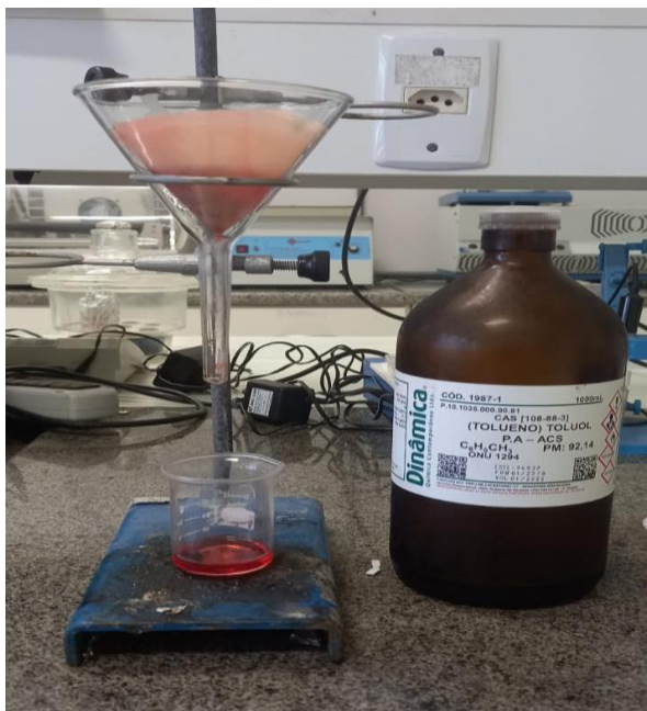
Figura 23 - Processo de filtração com tolueno do CABar saturado com corante Sudan IV
