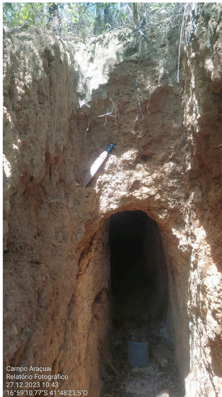
Figura 17 - Amostragem de saprolito em quase contato total com a saída do túnel (amostra 4).
