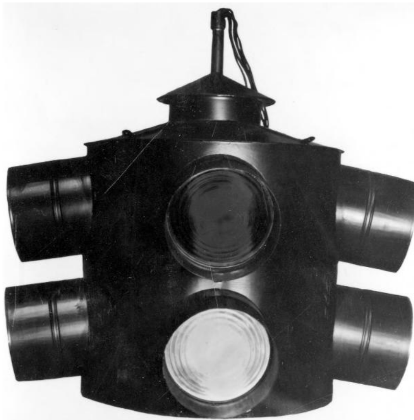
Figura 6 – Semáforo de Lester Wire.
