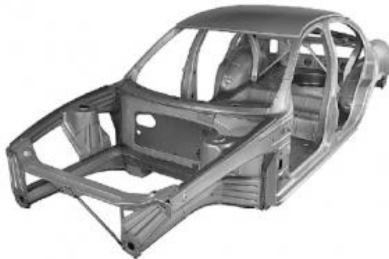
Figura 3 – Chassi do tipo monobloco
