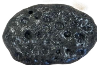
Figura 21 - Espuma C0% sinterizada a 1000 °C
