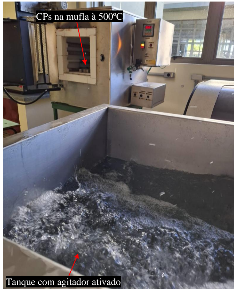
Figura 22 – Ensaio de choque térmico.
