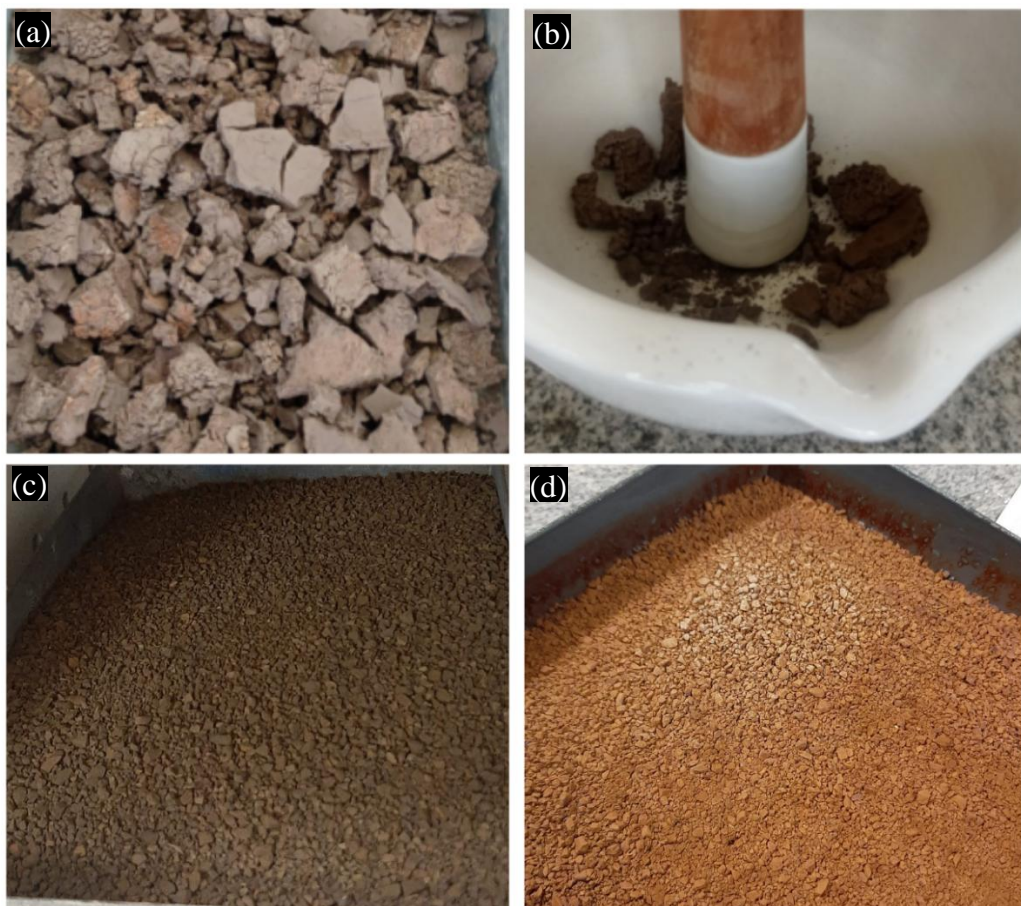
Figura 13 – Lodo (a) seco; (b) destorroadado; (c) antes da calcinação; (d) calcinado.
