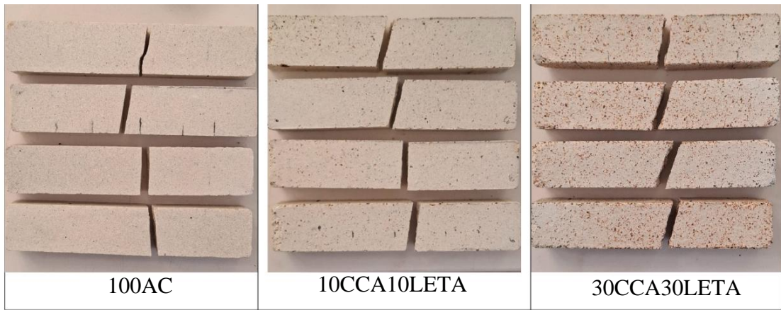
Figura 50 – Resultados dos CPs após o ensaio de RF4P.
