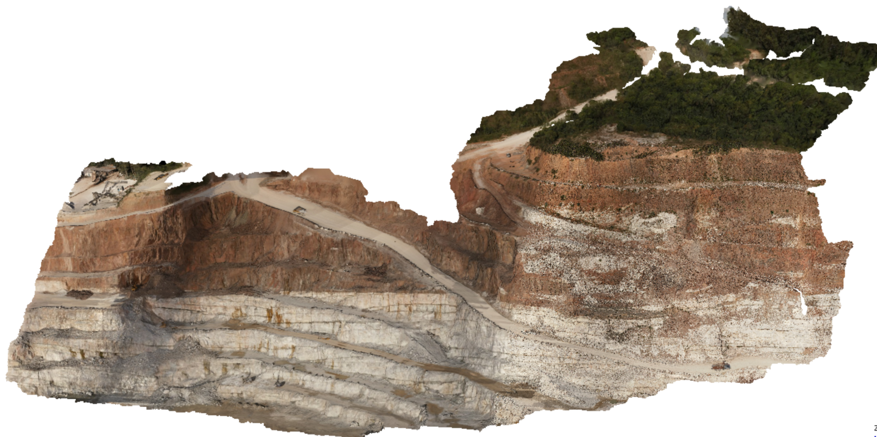
Figura 13 – Modelo tridimensional texturizado da área de estudo obtido por processamento fotogramétrico.
