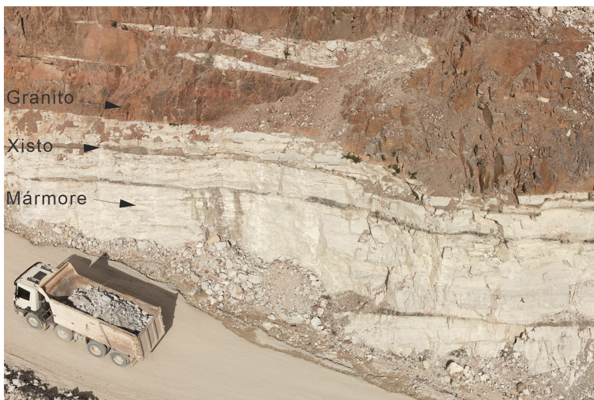
Figura 7 – Perfil das principais litologias observadas na área de estudo: o mármore, o xisto e o granito.
