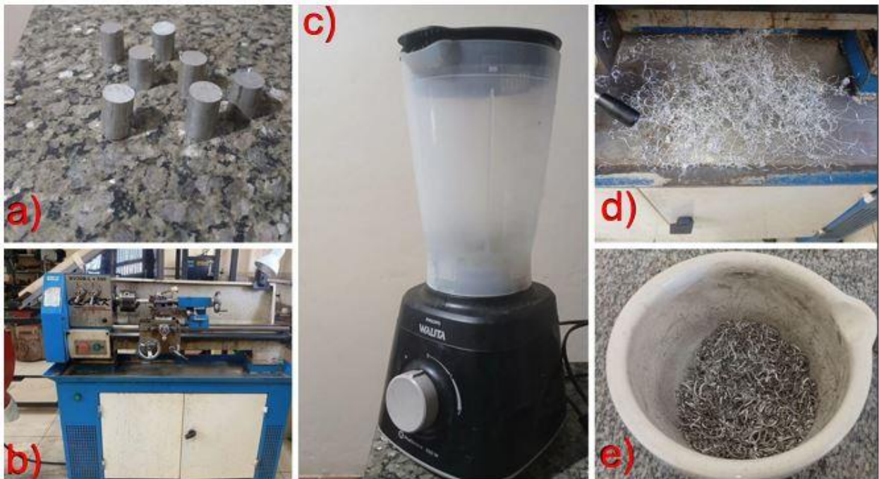
Figura 3.4 - (a) Barra de Al cortada com 35 mm e 150 mm; (b) torno usado para a usinagem da barra de Al; (c) liquidificador; (d) cavaco após a usinagem (antes do liquidificador) e (e) cavaco após moagem pelo liquidificador.
