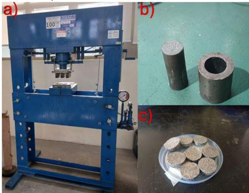
Figura 3.7 - (a) Prensa hidráulica; (b) molde usado para o embutimento da mistura; (c) pastilhas de cavaco com material 2D.
