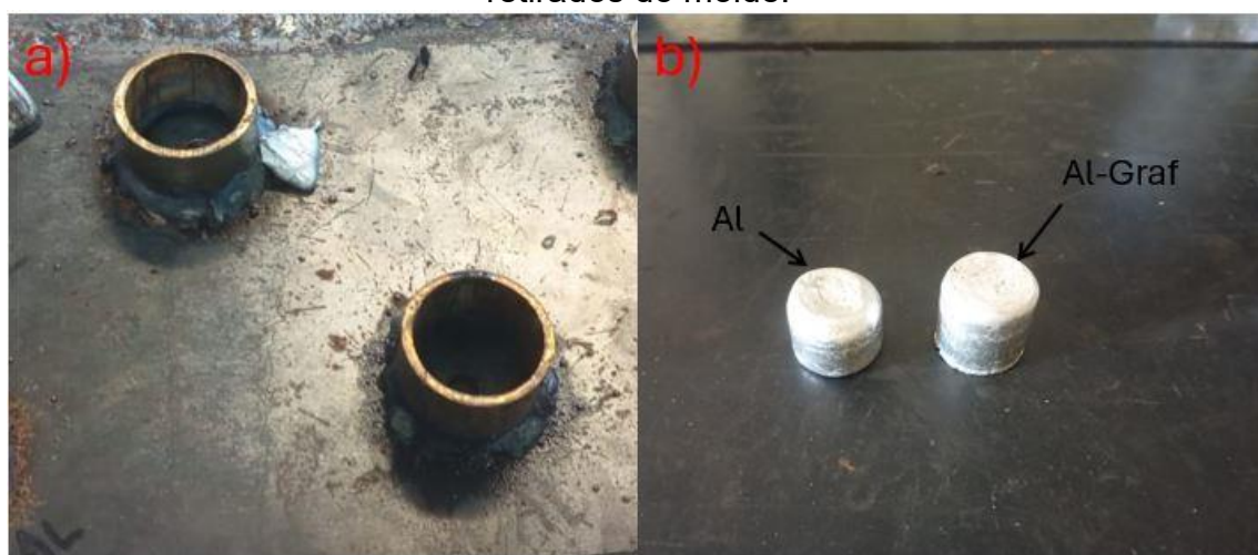
Figura 3.9 - Molde usado para fazer os corpos de prova fundidos; (b) Corpos de provas retirados do molde.
