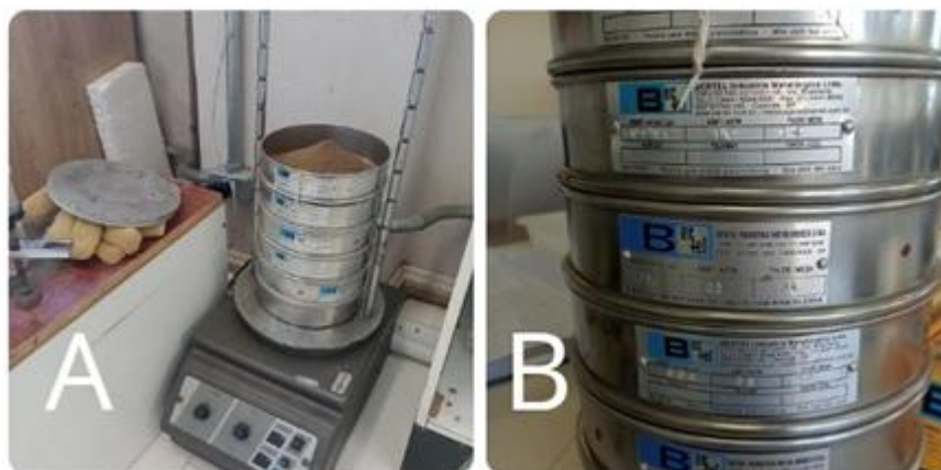
Figura 6: Granulometria do bagaço moído (A - Série de peneiras na mesa agitadora; B - Peneiras em sequência).
