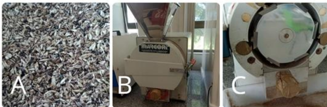
Figura 5: Moagem do bagaço seco (A - malte seco; B - moinho de facas (modelo MA-580); C - moagem).
