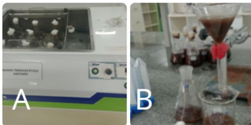
Figura 9: A - Banho agitado; B - Filtração
