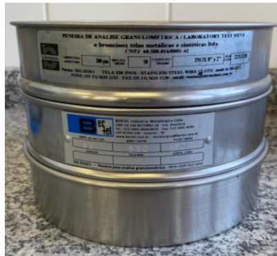
Figura 13- Conjunto de peneiras para separação dos fragmentos de vidro
