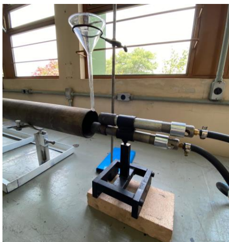
Figura 15- Funil utilizado para deposição dos fragmentos de vidro na chama
