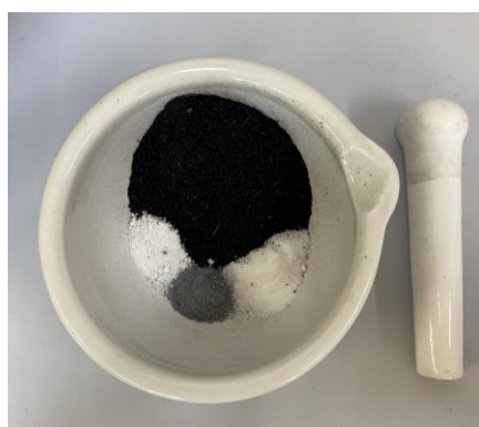
Figura 8- Materiais utilizados para homogeneização (a) e conjunto homogeneizado (b)
