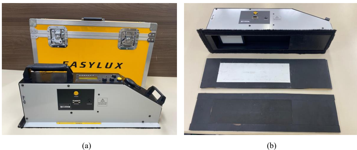
Figura 20- Retrorefletômetro horizontal clássico (a) e superfícies de medições sem uso de tinta e com uso de tinta (b)
