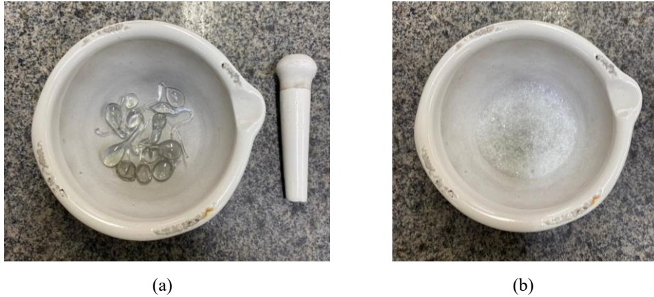
Figura 12- Materiais utilizados para moagem do vidro (a) e vidro moído (b)
