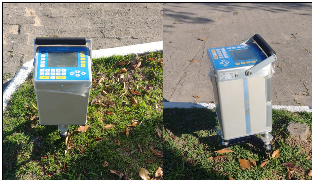
Figura 14. Medidas com o gravímetro na Estação Gravimétrica Base - Campus Unipampa Caçapava do Sul.
