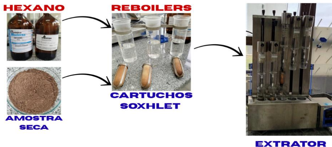
Figura 10 – Esquema da obtenção do teor de Lipídeos método de extração Goldfish
