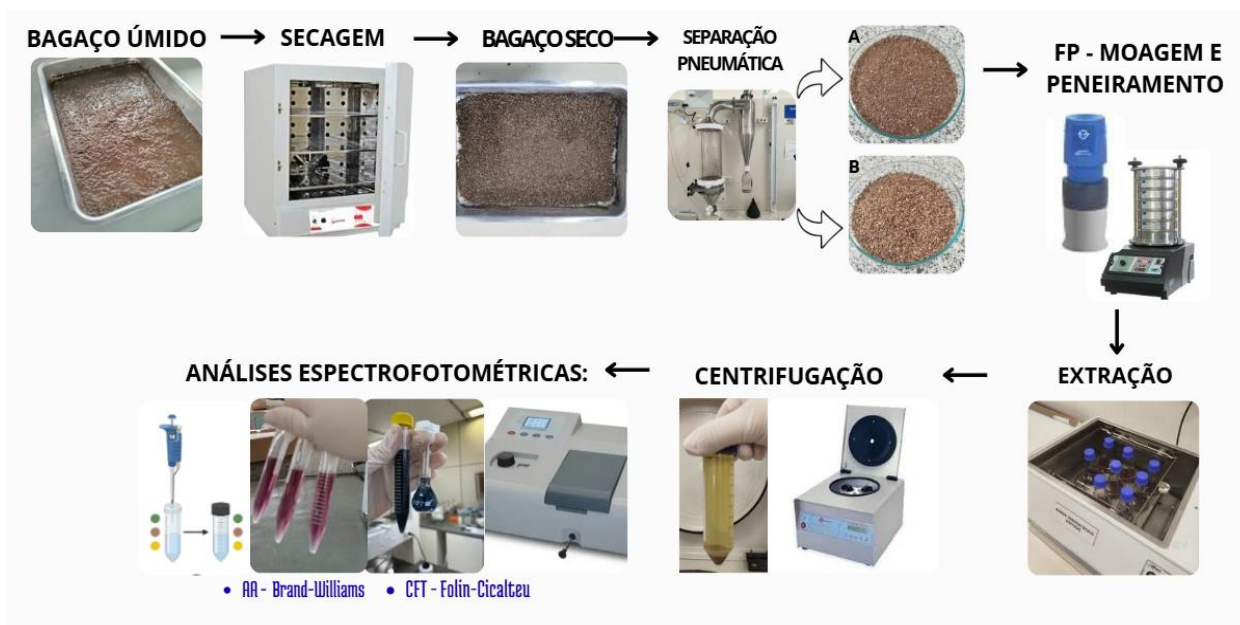
Figura 11 – Esquema de obtenção e caracterização do extrato
