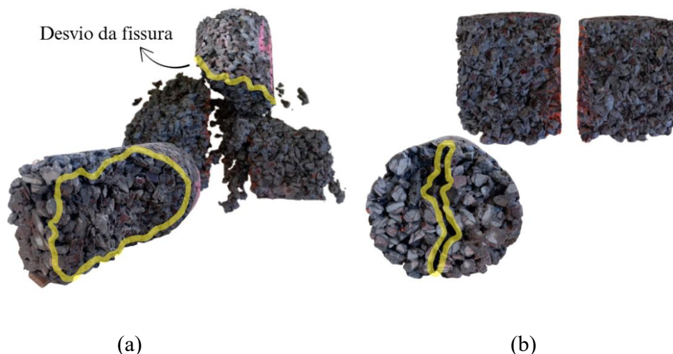
Figura 16 - Padrão de fissuração do gradiente na vertical (a) e na horizontal (b)
