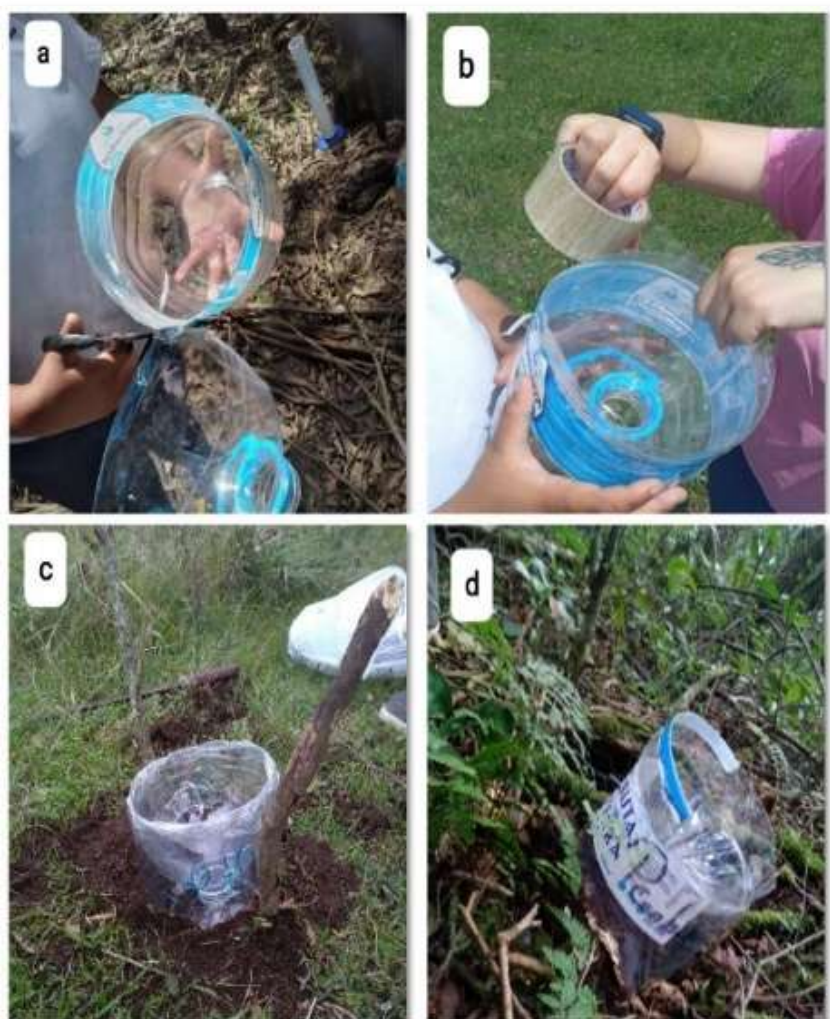
Figura 4 - Detalhes da construção e instalação dos coletores: a) Corte da parte superior b) Instalação do funil c) Coletor da área externa d) Coletor da área interna
