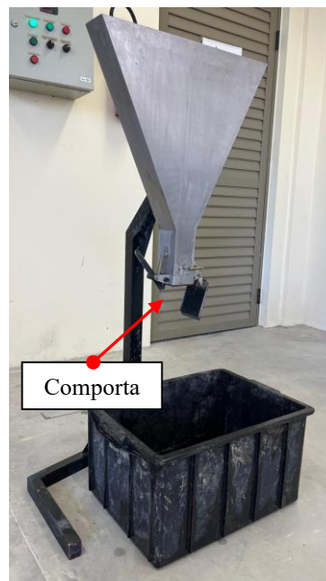
Figura 22 – Configuração do ensaio do Funil V, normatizado pela NBR 15823-5 (ABNT, 2017)
