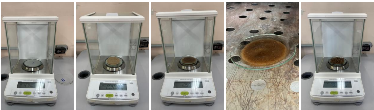
Figura 14 – Etapas do procedimento de caracterização do aditivo químico: a) teor de sólidos e b) massa específica, conforme a norma NBR 11768-3 (ABNT, 2019)
