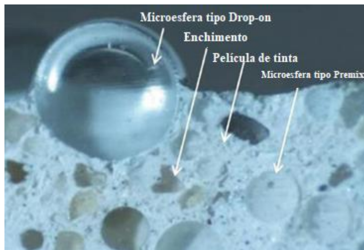
Figura 5: Deposição de microesferas sinalizações horizontais.
