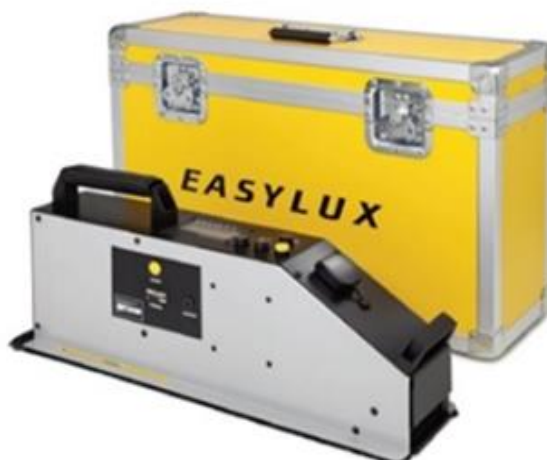
Figura 25: Retrorrefletômetro Easylux utilizado nas medições de retrorrefletividade.
