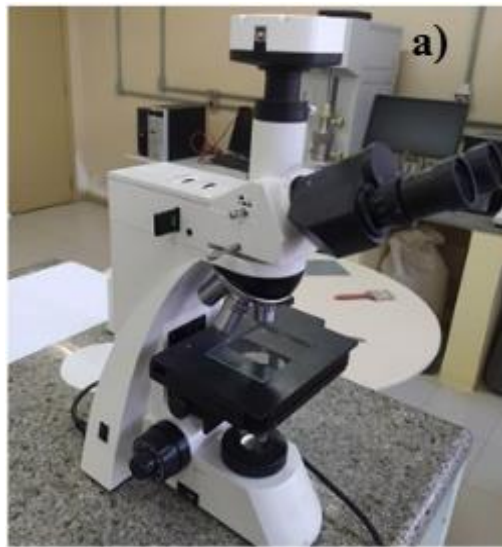
Figura 23: Microscópio óptico trinocular usado para avaliação morfológica e granulométrica.
