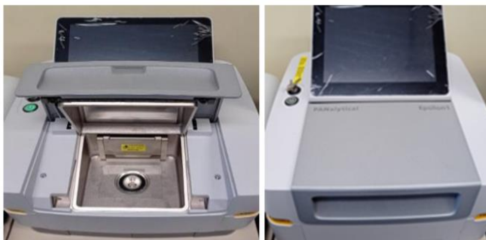
Figura 20: Equipamento FRX para avaliar a composição dos vidros
