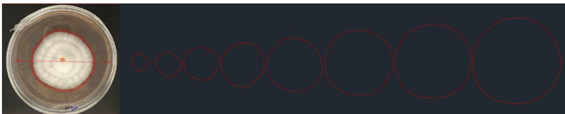
Figura 1: Esquema de medida da área do crescimento micelial no programa AutoCAD e exemplo de evolução do crescimento.
