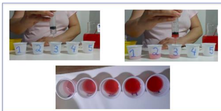
Figura 4. Esquema protocolo para a diluição das amostras utilizando as seringas e copos descartáveis. A) adição do volume do diluente água. B) adição do analito suco. C) representação das cinco concentrações prontas.
