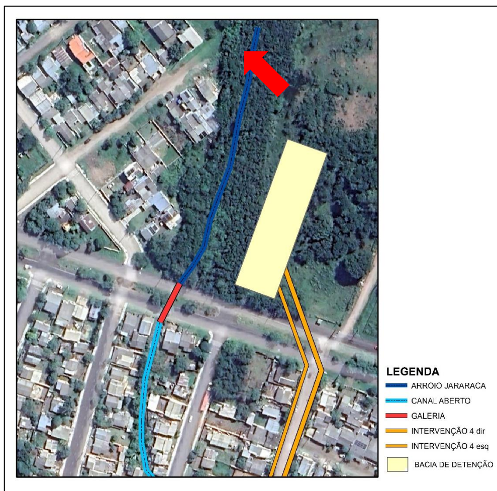
Figura 46 - Tubulação e respectiva condução das águas
