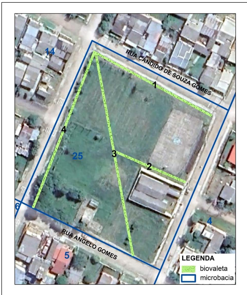
Figura 40- Intervenção 2 proposta – disposição das biovaletas
