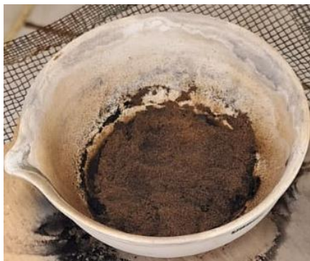
Figura 18 – CRS1 após queima em bico de bunsen
