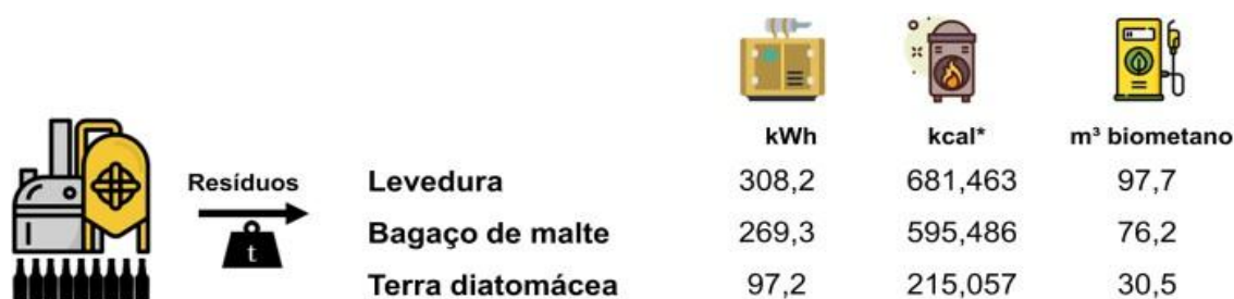
Figura 6 - Esquema de geração de energia a partir de 1 tonelada de resíduo
