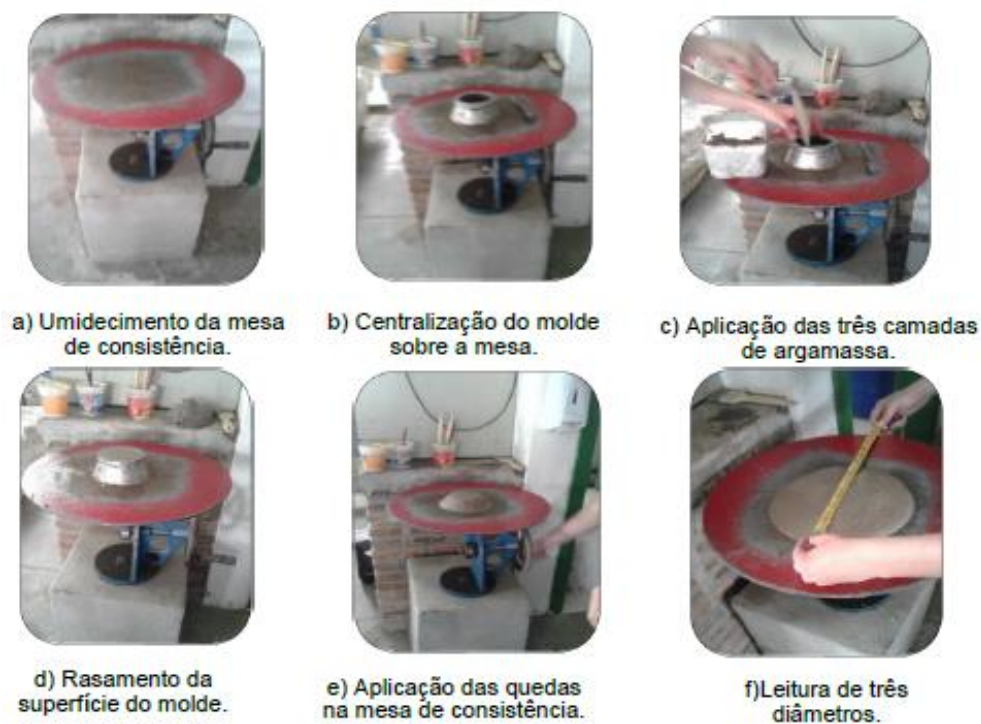
Figura 7 - Etapas de execução do ensaio de índice de consistência.
