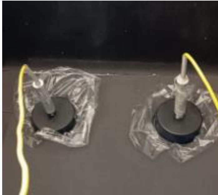
Figura 25 – Inserção do termopar nas amostras.
