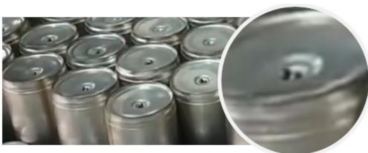
Figura 48 - Posicionamento de material selante
