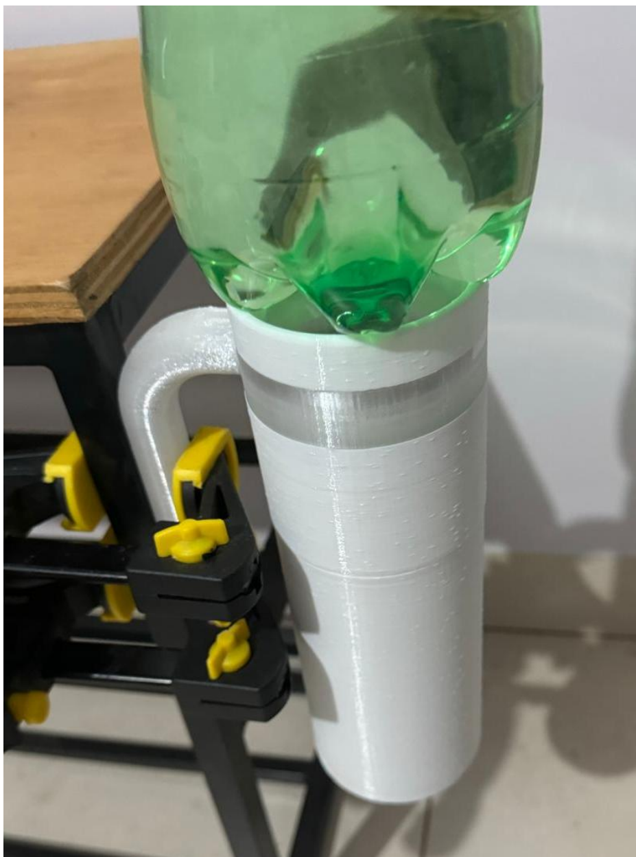
Figura 56 - Ensaio de resistência da alça
