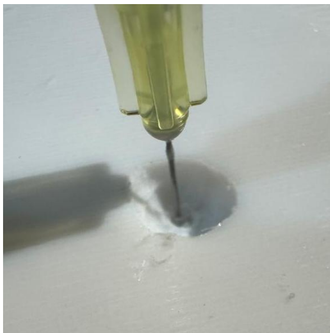
Figura 37 - Agulha perfurando o orifício de extração de ar
