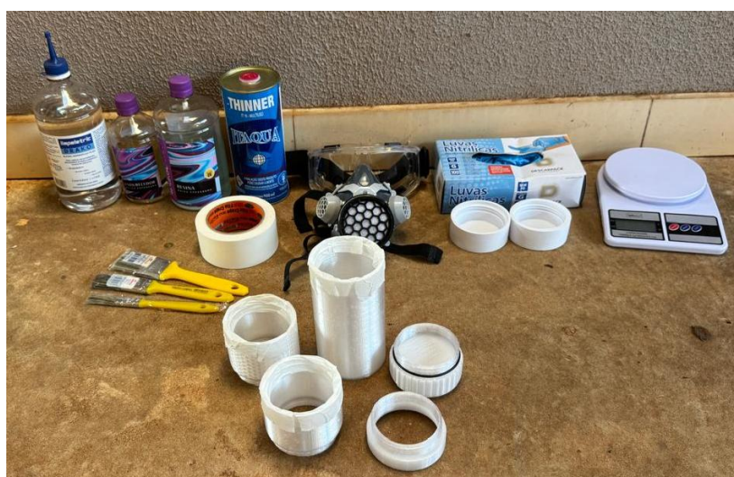
Figura 38 - Equipamentos utilizados na aplicação de resina epóxi
