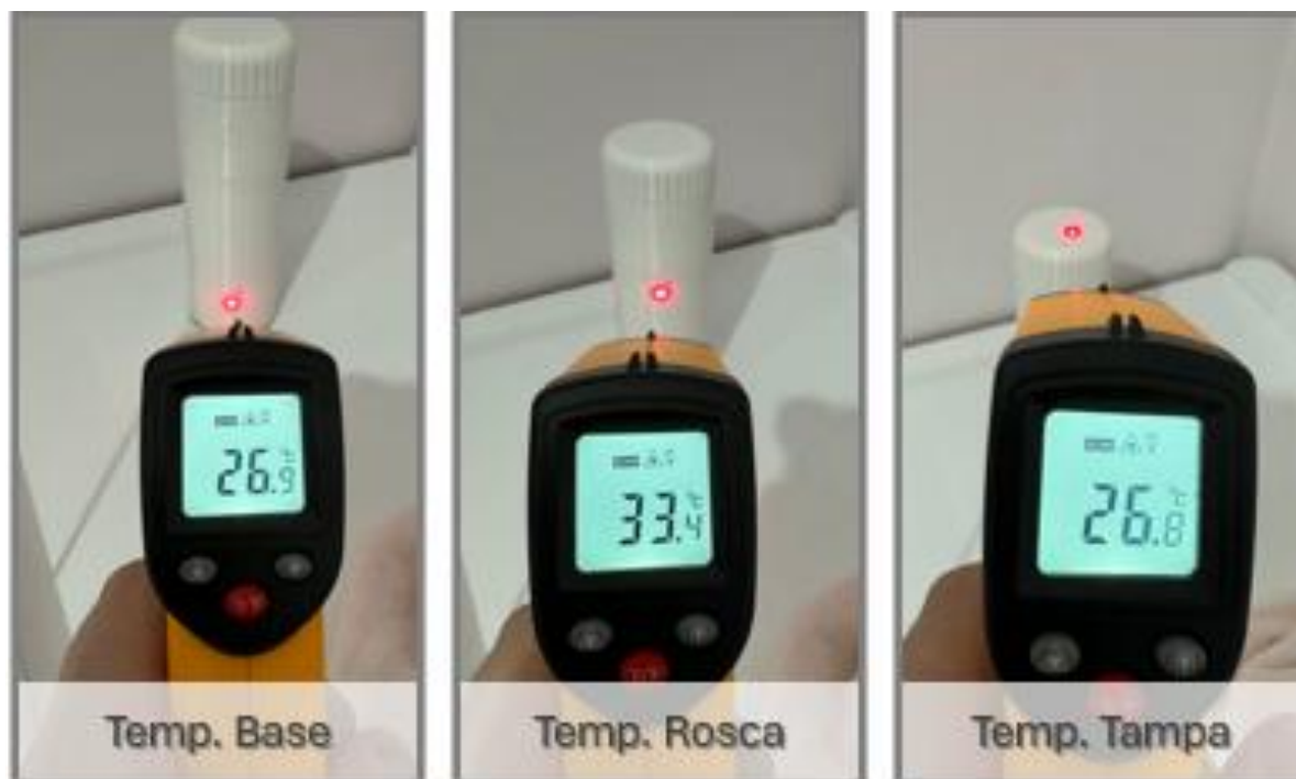
Figura 51 - Análise dos pontos de dissipação de calor
