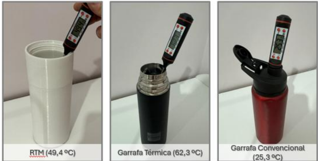
Figura 52 - Temperaturas finais do ensaio de eficiência a alta temperatura
