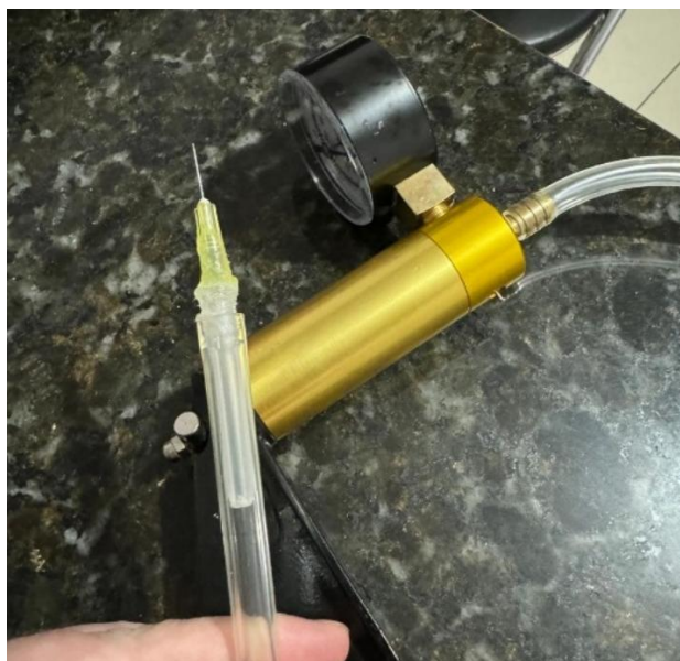
Figura 36 – Agulha adaptada em uma bomba manual
