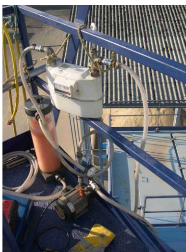
Figure A - 28 – Détail du cartouche avec desséchant, du dispositif de réglage du débit, dispositif d'aspiration et mesure de volume
