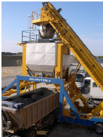
A) Décharge des enrobés
