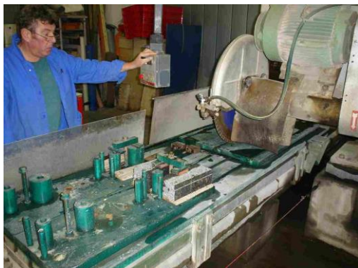
Figure A - 11 - Sciage et confections des éprouvettes trapézoïdales d'enrobé bitumineux
