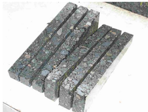
Figure A - 11 - Sciage et confections des éprouvettes trapézoïdales d'enrobé bitumineux
