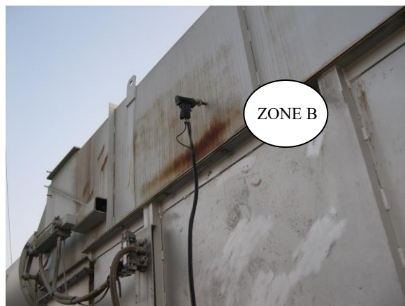
Figure 3 - 5 –Emplacement des prélèvements à la sortie du sécheur
