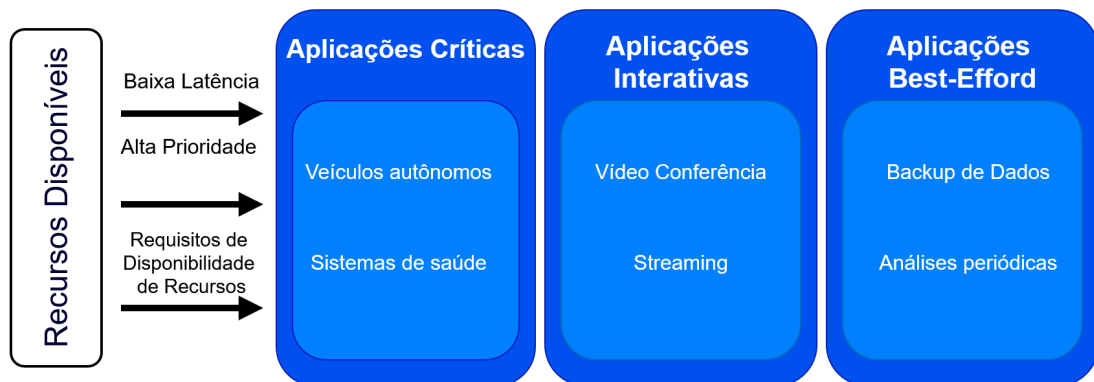
Figura 2 – Classificação de aplicações de borda por criticidade e requisitos de provisionamento. Serviços críticos demandam baixa latência e alta prioridade de agendamento, enquanto aplicações do tipo best-effort toleram atrasos e podem ser adiadas em condições restritas.
