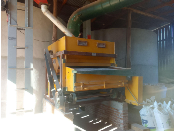
Figura 12. Máquina de pré Limpeza do engenho e ao lado o elevador de grãos.
