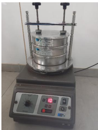
Figura 10 - Sistema de peneiramento utilizado no preparo físico da cinza pesada
