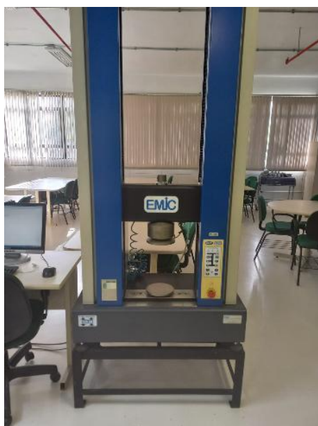
Figura 19 - Máquina universal de ensaios EMIC DL 20000
