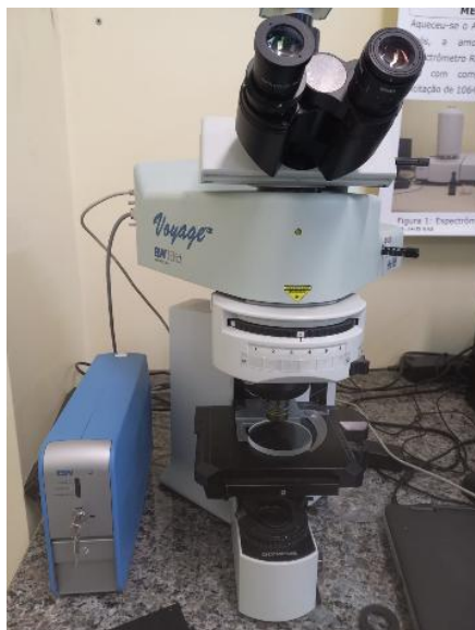
Figura 12 - Espectrômetro Raman utilizado na análise estrutural da cinza pesada
