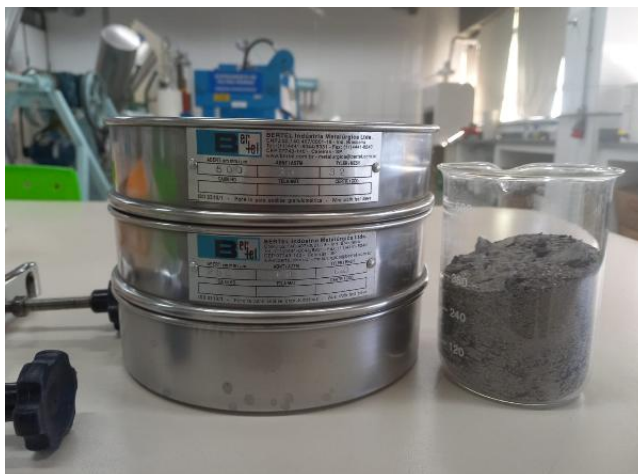
Figura 13 - Sistema de peneiramento utilizado na classificação granulométrica
