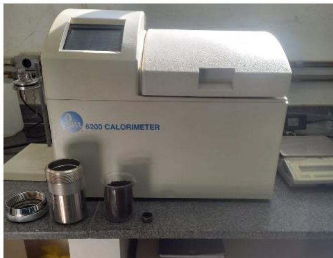
Figura 9 - Sistema de calorimetria Parr 6200 com bomba calorimétrica
