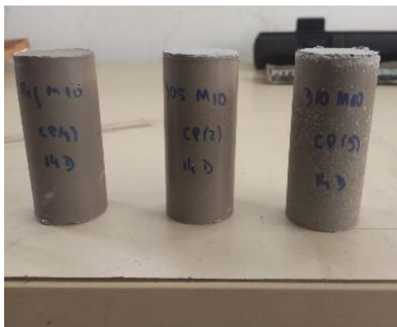
Figura 17 - Corpos de prova geopoliméricos após 14 dias de cura
