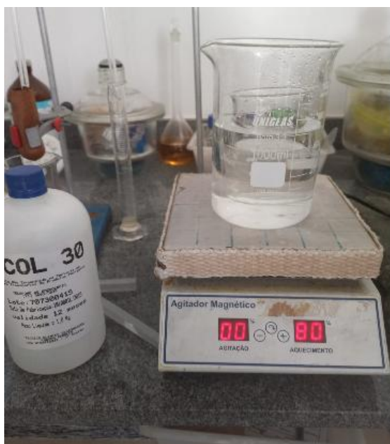
Figura 8 - Preparo da fonte silicatada sólida a partir da solução de Sicol 30
