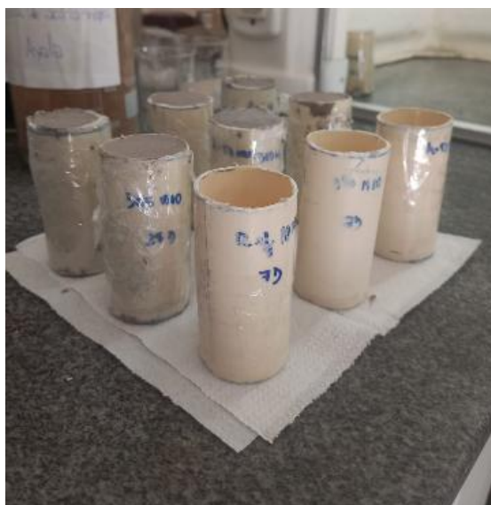
Figura 16 - Moldes de PVC para obtenção dos corpos de prova geopoliméricos
