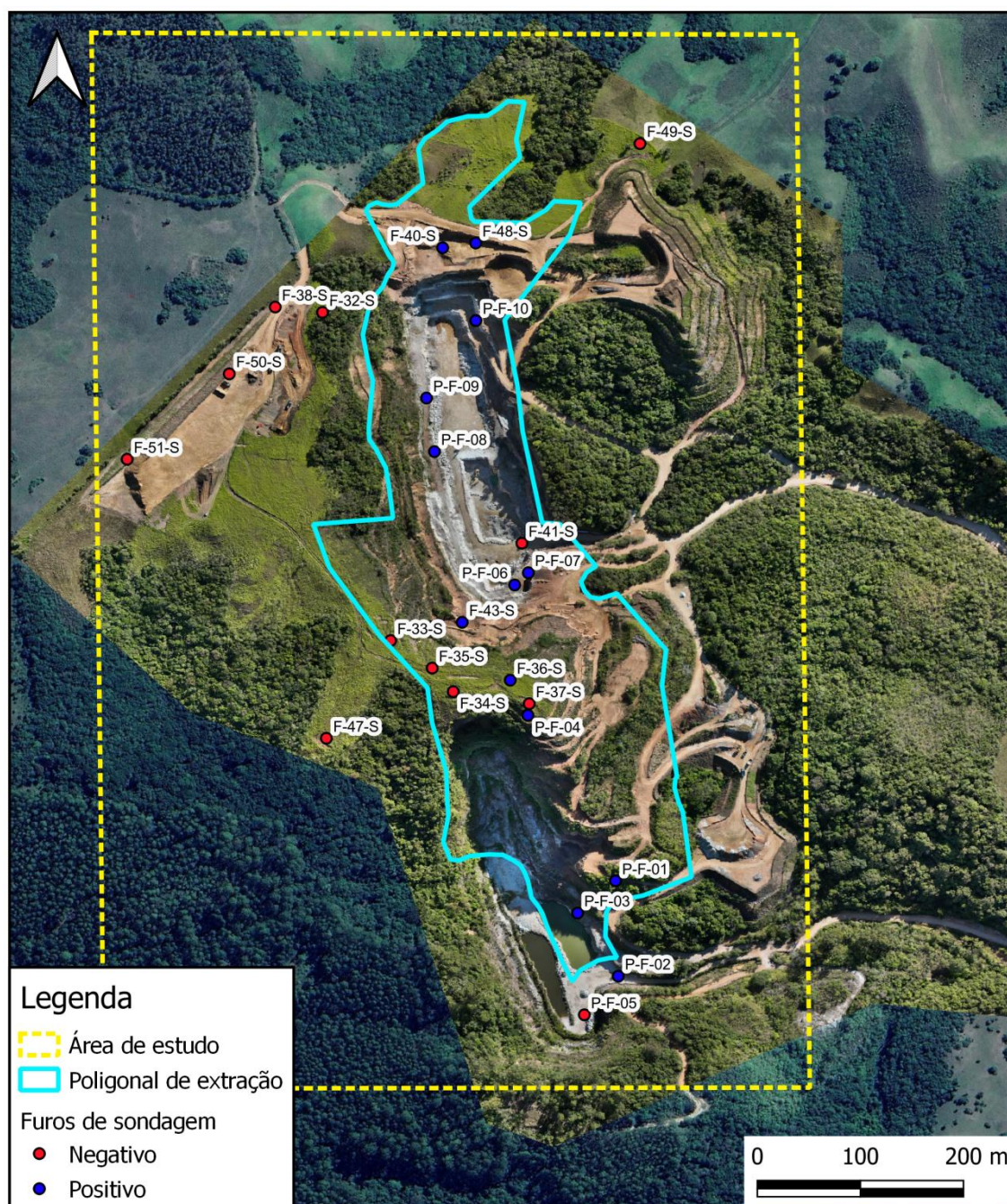
Figura 12 - Localização espacial dos furos de sondagem. Os furos azuis foram classificados como positivos e os vermelhos, negativos.
