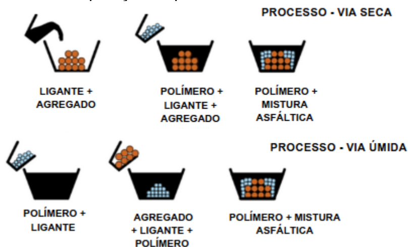
Figura 4 - Processos de incorporação de polímeros em misturas asfálticas.
