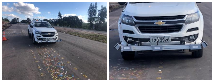
Figura 35 - Avaliação de IRI nos segmentos A, B e C
