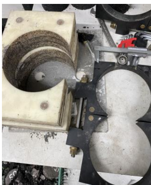
Figura 32 - Formas utilizadas no ensaio Hamburg Wheel Tracking Test: Fornecida de fábrica (direita) e substituta (esquerda)
