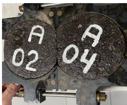
Figura 28 - Confinamento de aproximadamente metade da altura das amostras
