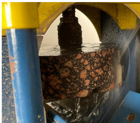
Figura 26 - Corte para adaptação ao dispositivo de deformação
