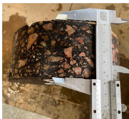
Figura 27 - Medição da espessura do corpo de prova com paquímetro
