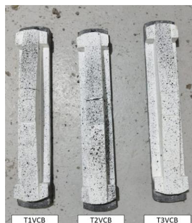
Figura 34 - Corpos de prova viga TVCB após o segundo ensaio.
