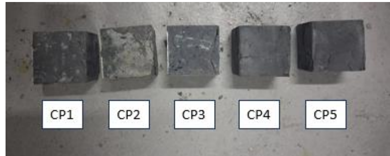
Figura 20 – Corpos de prova após ensaio de compressão axial.
