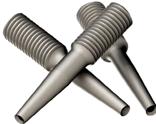
Figura 28 – Indentadores cônicos usinados.
