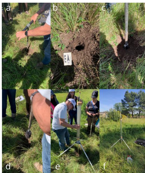
Figura 19 - a) Abertura do poço. b) Poço onde será feito o ensaio. c) Trado de Entalhe. d) Escova para expor a matriz do solo. e) Instalação do Permeômetro de Guelph. f) Equipamento pronto para uso.
