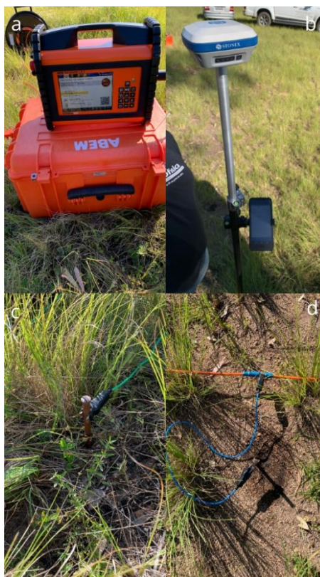
Figura 17 - a) Equipamento utilizado nos levantamentos geofísicos. b) GPS Diferencial. c) e d) Eletrodos da linha geofísica.
