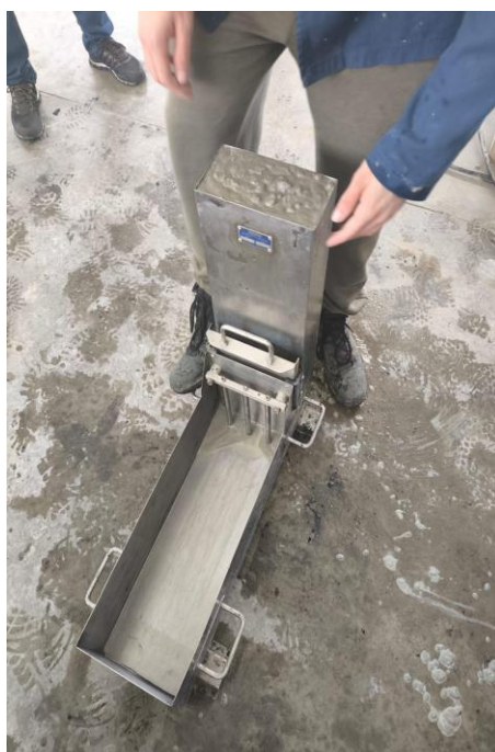
Figura 23 - Imagem da Caixa L com concreto na parte vertical antes da abertura da comporta
