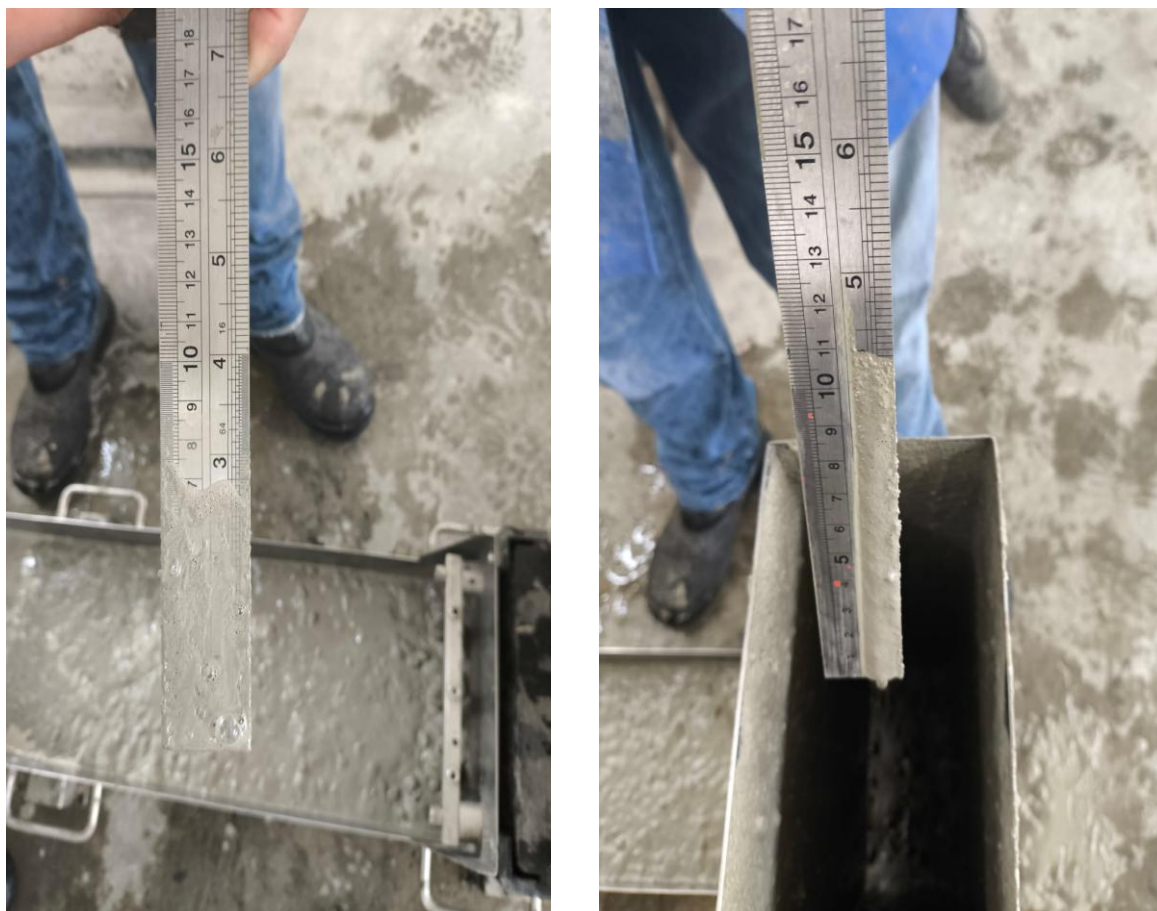
Figura 24 - Imagem do ensaio da Caixa L, medidas H1 e H2
