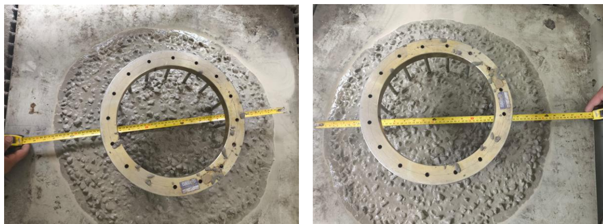
Figura 22 - Imagem registrada ao final do ensaio do Anel J
