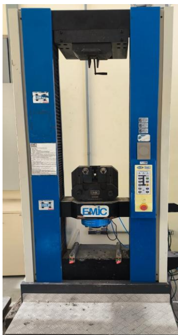
Figura 20 - Máquina Universal de Ensaios Mecânicos EMIC DL 2000.
