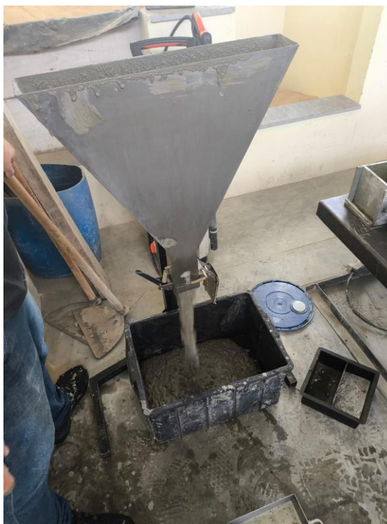
Figura 25 - Imagem registrada durante a da execução do ensaio no Funil V
