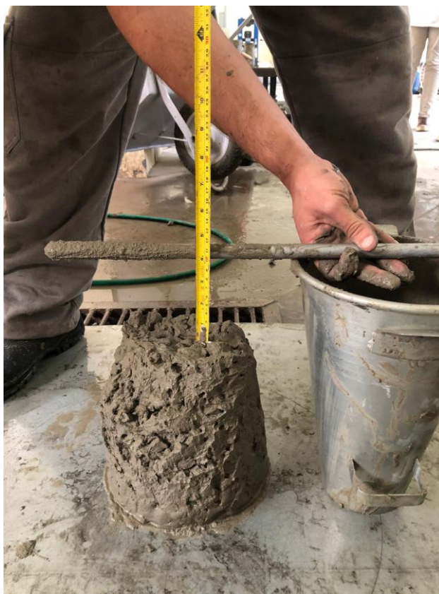
Figura 26 - Imagem registrada durante a da execução do slump test
