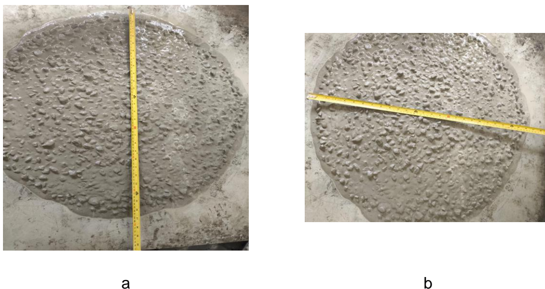
Figura 21 - Imagem ao final do espalhamento – Cone de Abrams
