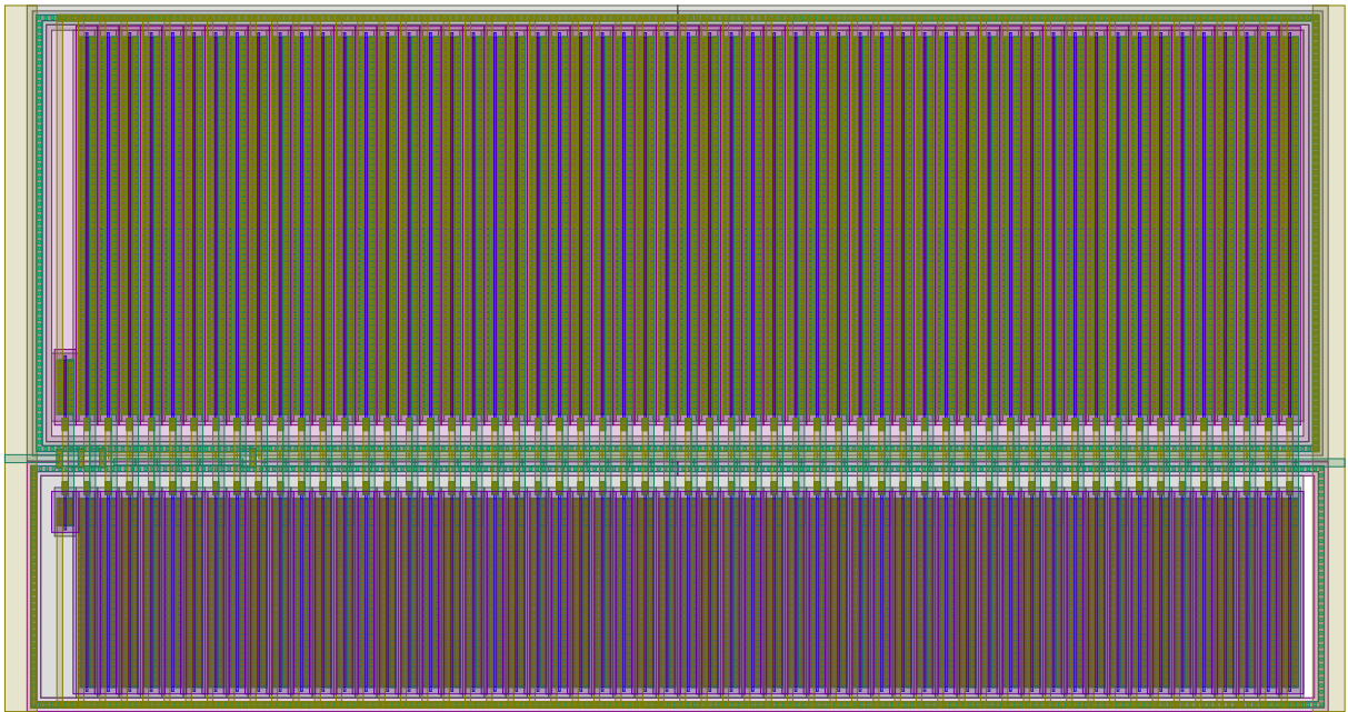
Figura 53 – Layout do buffer aplicado aos bits de saída do ADC.
