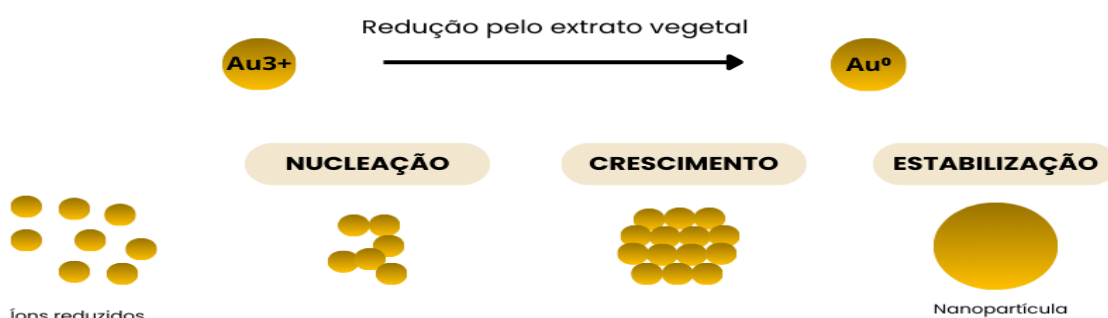
Figura 6 - Etapas de formação de NPs-Au pelo método de síntese verde
