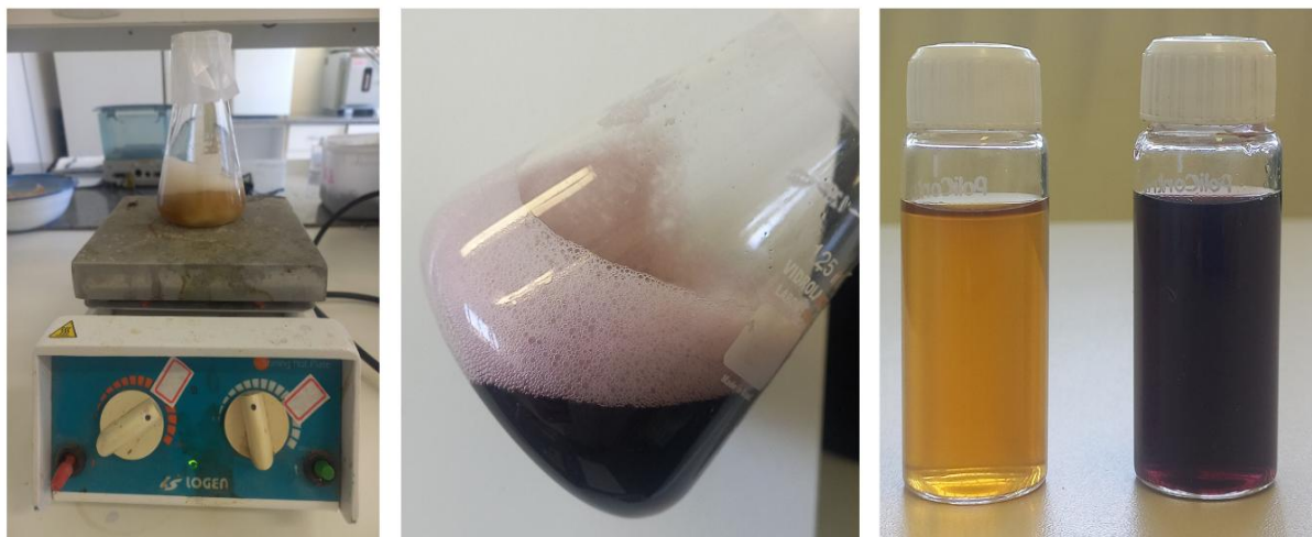
Figura 11 - Mudança de coloração evidenciando a formação das nanopartículas
