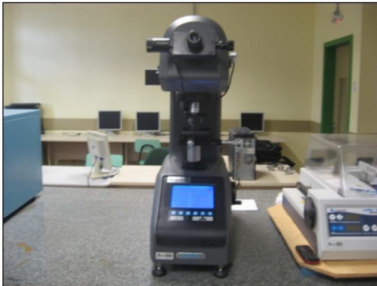
Figura 26 – Microdurômetro marca Buehler
