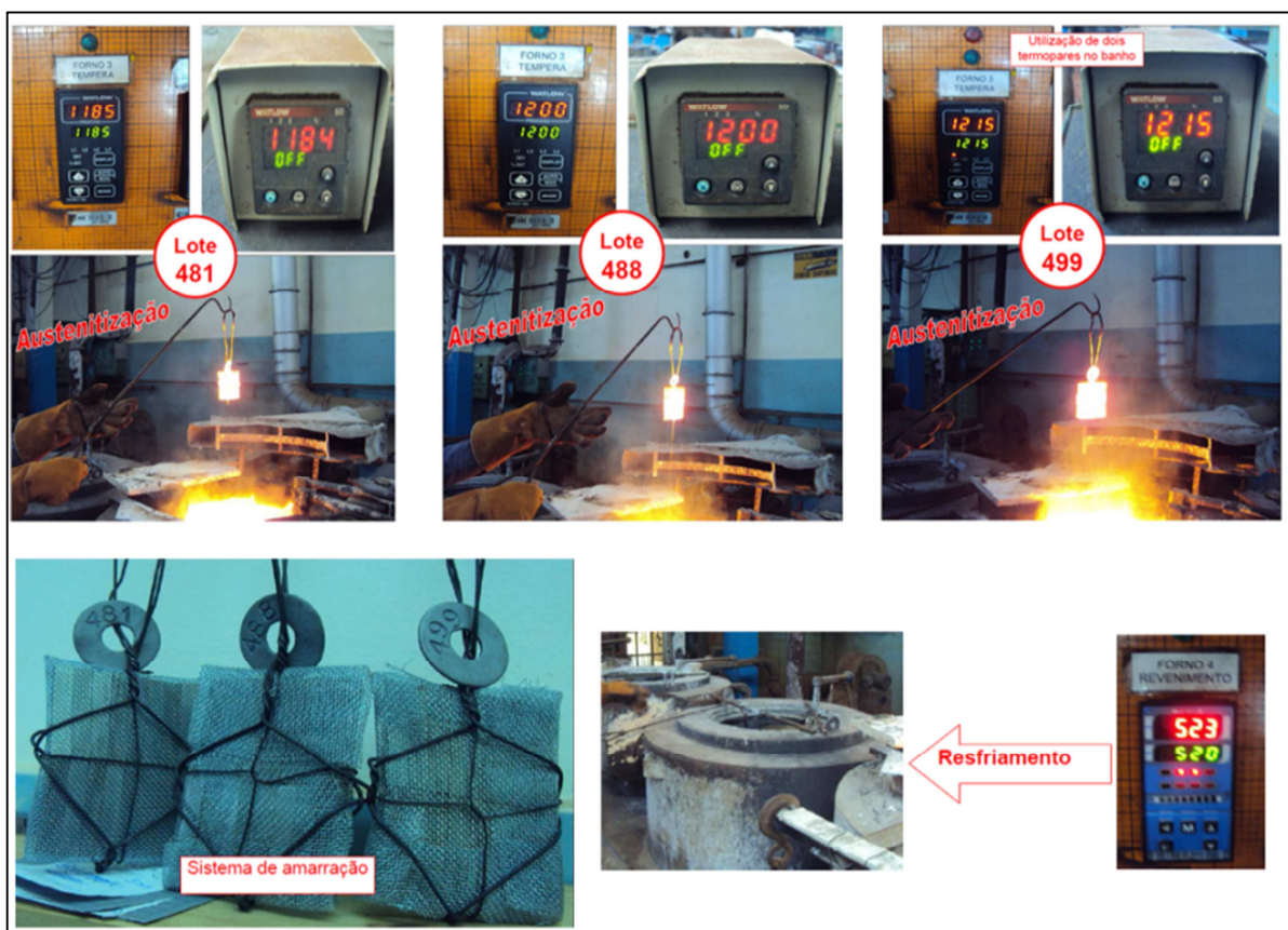
Figura 18 – Detalhes durante o processo de austenitização e têmpera
