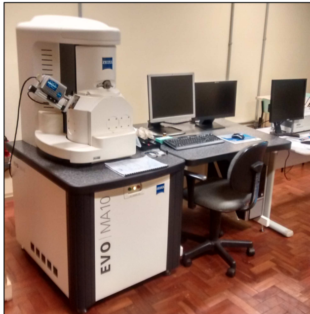
Figura 27 – Microscópio eletrônico de varredura marca Zeiss, modelo EVO MA10
