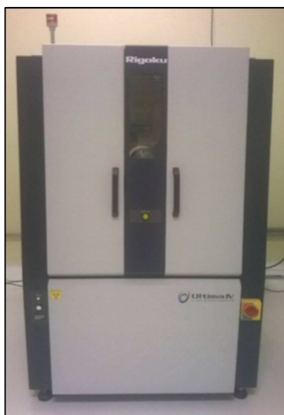
Figura 28 – Equipamento para difração de raios X, marca Rigaku, modelo Ultima IV
