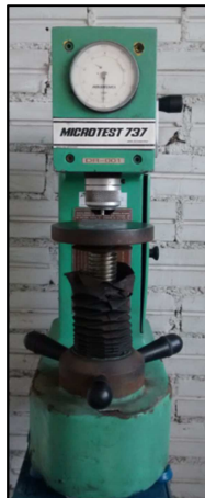
Figura 22 – Durômetro Indústécnica para medição da dureza Rockwell C
