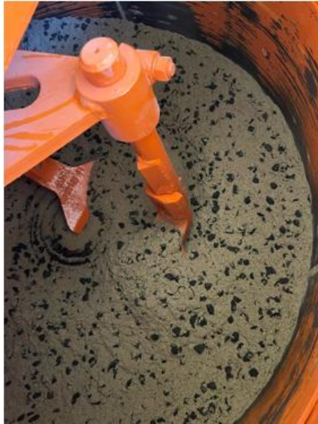
(a) Adição dos agregados
