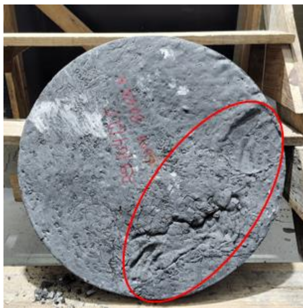
Figura 32 – Tampa danificada na cura
