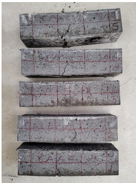
Figura 31 – Corpos de prova prismáticos após ensaio de Resistência à tração na flexão em 4 pontos
