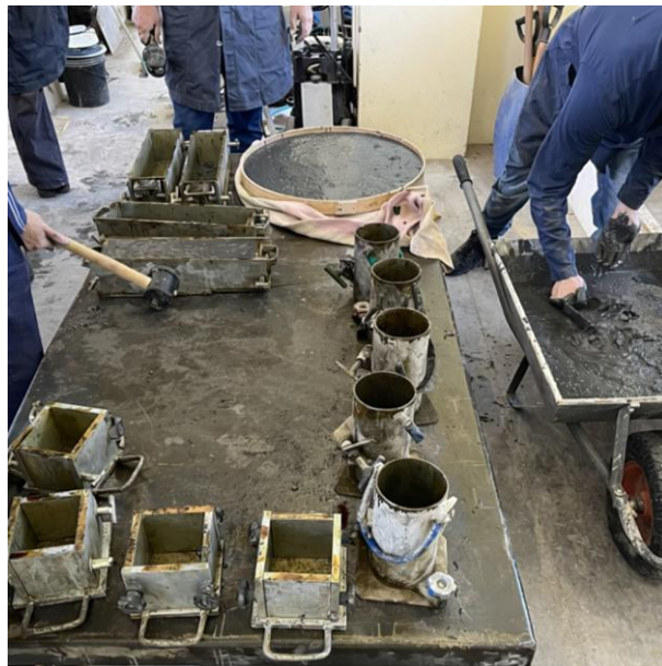
Figura 15 – Moldagem dos corpos de prova
