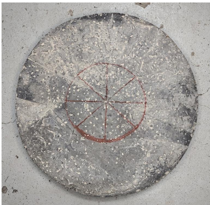
Figura 23 – Delimitação da área a receber o carregamento
