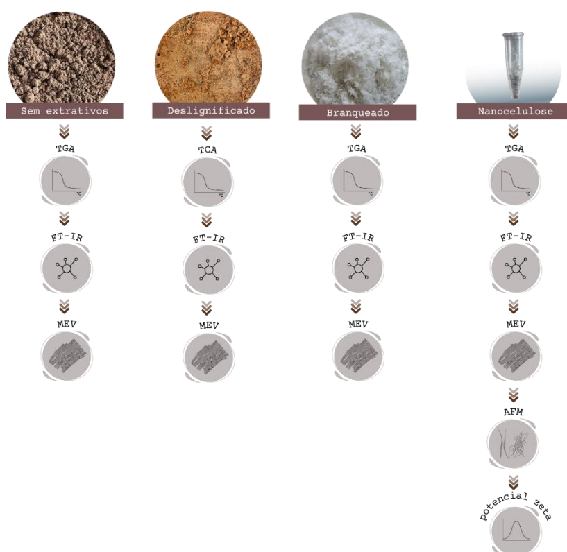
Figura 3 - Caracterizações realizadas nas etapas de pré-tratamento e na nanofibrila de celulose sinterizada.
