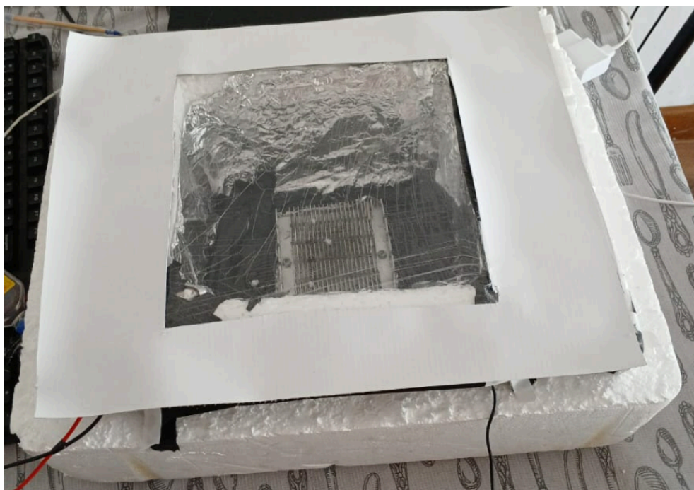
Figura 15- Sistema isolado com filme PVC e lona.
