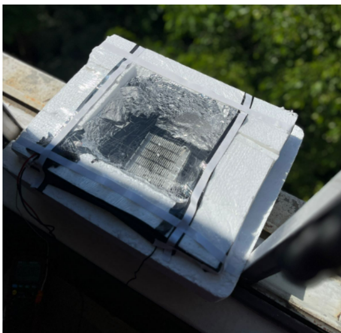
Figura 19 - Isolado com filme PVC (sem resfriamento submerso).
