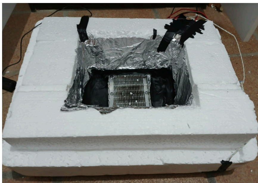
Figura 11 - Sistema isolado com Poliestireno, papel alumínio e fita isolante.
