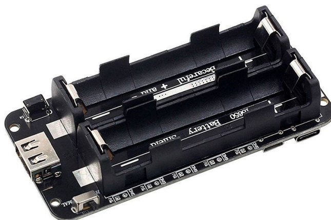
Figura 22 – Shield de Bateria para Alimentação.
