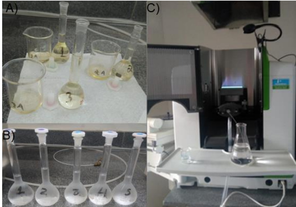
Figura 14 - Espectroscopia de absorção atômica: A) Carvão digerido; B) Padrões analíticos de ferro reduzido de 1 a 5 ppm; C) Equipamento Pinaacle 900H em funcionamento
