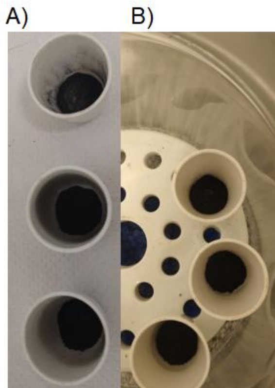
Figura 11 - Verificação da quantidade de voláteis: A) Antes do aquecimento; B) após aquecimento
