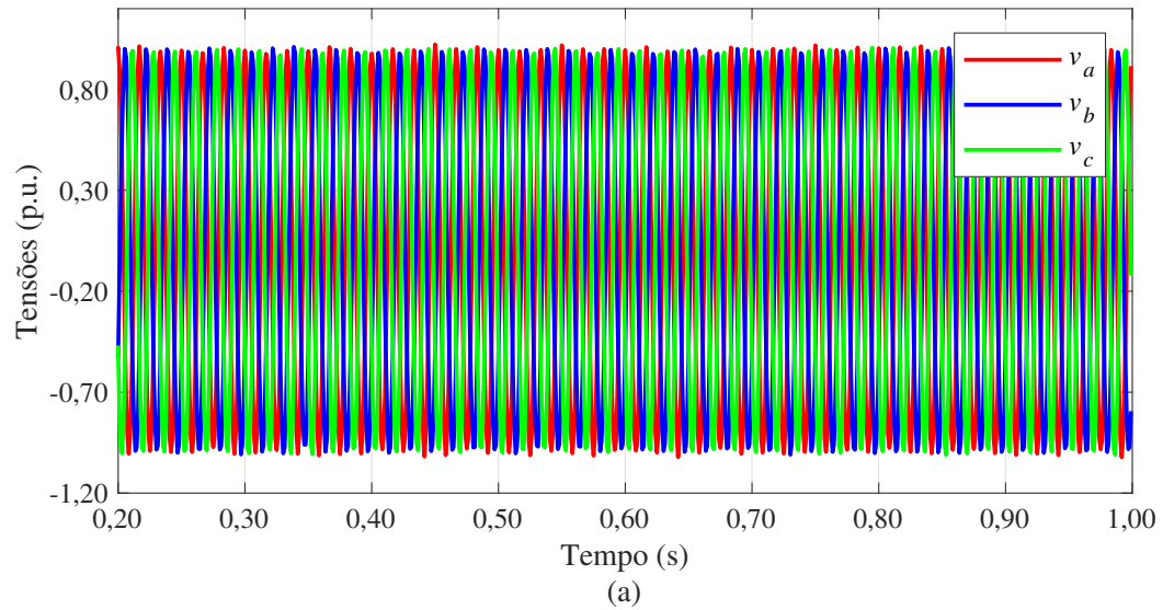
Figura 23 – Resultados para o caso de sinais com ruído em 16 amostras/ciclo ( f = 60 Hz e SNR = 40 dB). (a) Sinais de tensão de entrada (b) Estimação de frequência. (c) Erro absoluto de estimação.
