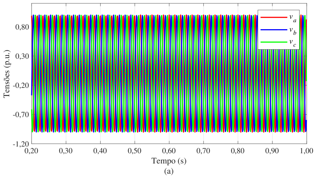
Figura 15 – Resultados para o caso de variação de fase de 10^\circ com 16 amostras/ciclo. (a) Sinais de tensão de entrada (b) Estimação de frequência. (c) Erro absoluto de estimação.
