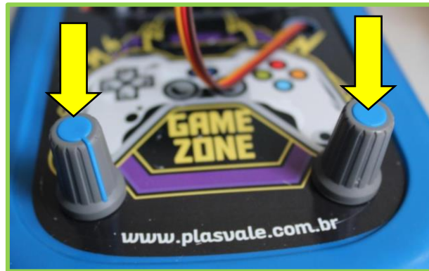
Figura 7 - Botões (Knob) para a movimentação dos servos
