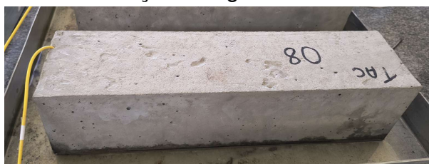
Figura 29 – Absorção de água em 72h TAC sem PC
