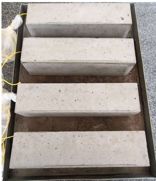
Figura 12 – Marcação do nível d'água no CP
