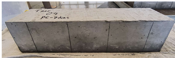
Figura 26 – Absorção de água em 72h TREF PC
