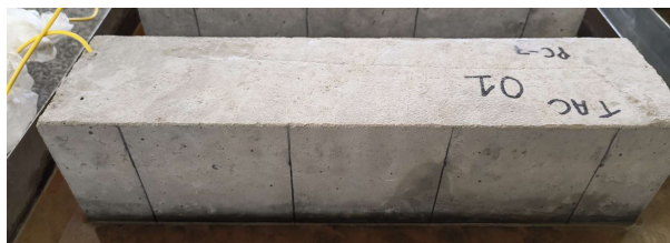
Figura 28 – Absorção de água em 72h TAC PC
