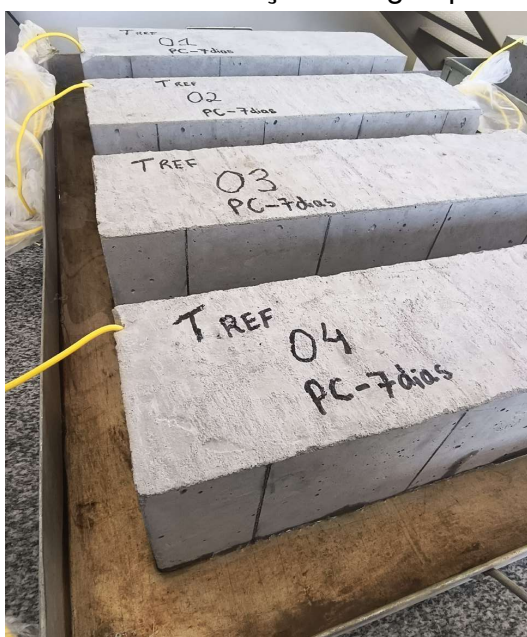
Figura 13 – Ensaio de absorção de água por capilaridade
