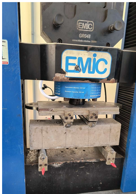
Figura 11 – Ensaio de tração na flexão
