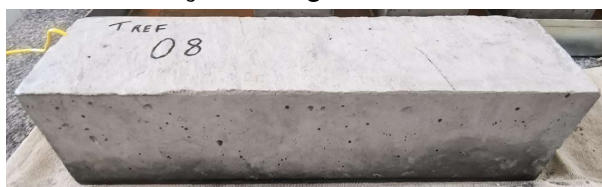
Figura 27 – Absorção de água em 72h TREF sem PC
