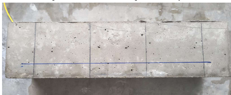
Figura 19 – Marcação do nível da solução salina para o ensaio CAIM
